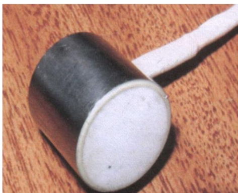
Rys. 7.18 Przetwornik pomiarowy WDAM-17 firmy Physical Acoustics Corporation (a) i jego charakterystyka częstotliwościowa (b) [233, 234].
