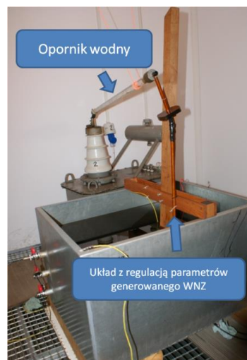
Rys. 8.3 Pulpit sterowniczy a) i model kadzi kondensatora elektroenergetycznego wypełniony olejem elektroizolacyjnym b).
