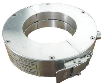
Rys. 7.24 Cewka Rogowskiego typ HVS 994-CT firmy M&B Systems Power Test Equipment (a), przykładowy przebieg czasowy (b) [243].
