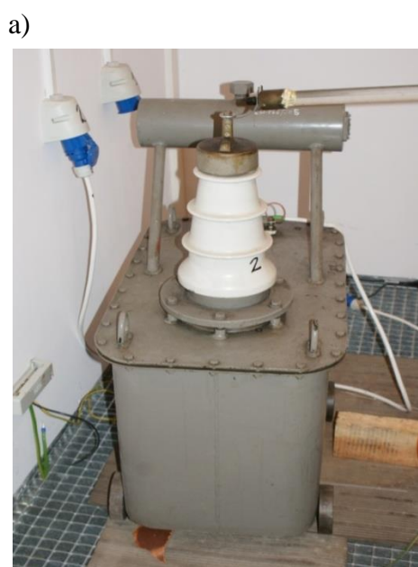
Rys. 8.2 Transformator probierczy typu TP60 (a), parametry znamionowe transformatora (b).
