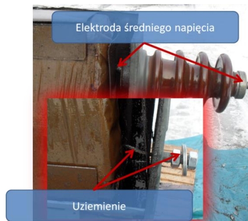
Rys. 5.3 Widok kondensatora zwijkowego, gdzie: a) usunięte elementy obudowy kondensatora, b) rozmieszczenie elektrod przyłączeniowych, roboczej i uziemiającej, opracowanie własne.
