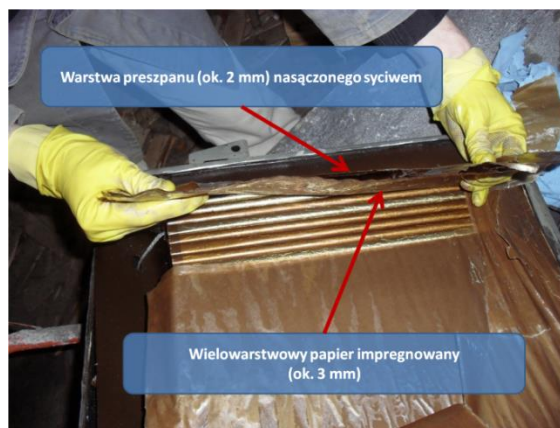
Rys. 5.4 Widok wielowarstwowej struktury preszpanu i papieru impregnowanego izolujących zestaw zwijek kondensatorowych, gdzie: a) widok wielowarstwowego papieru impregnowanego, w który owinięto zwijki kondensatorowe, b) widok zwijek kondensatorowych pod warstwą papieru impregnowanego, opracowanie własne.
