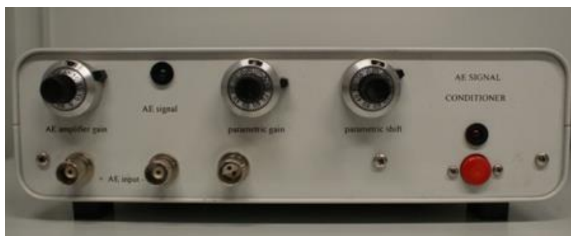
Rys. 7.21 Różnicowy wzmacniacz pomiarowy AE SIGNAL CONDITIONER (AESC) firmy AE System [237].
