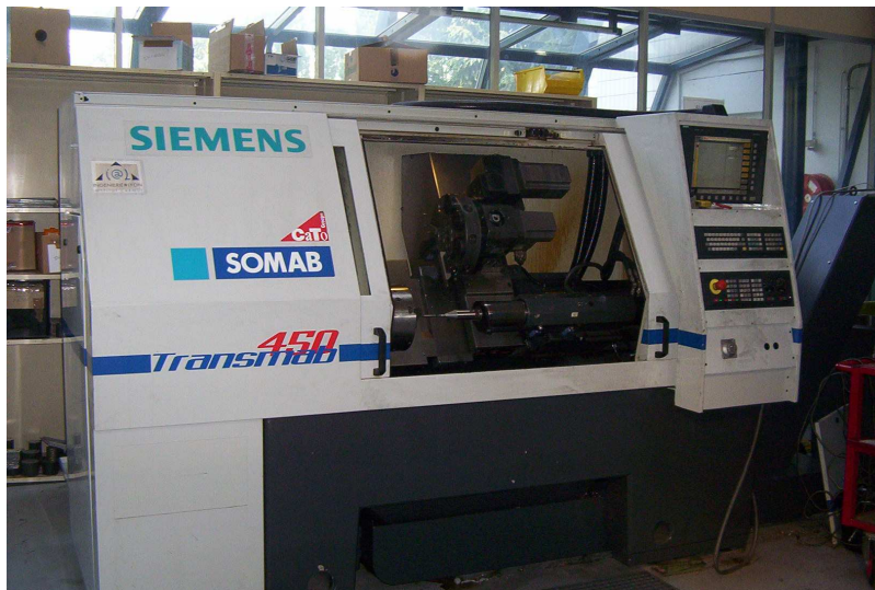
Rys. 4.1. Tokarka numeryczna firmy Somab (maksymalna moc napędu głównego 30 kW, maksymalna prędkość obrotowa – 3500 obr/min, zakres ruchów (x, z) – 500x1100 mm, magazyn narzędziowy na 12 narzędzi)
