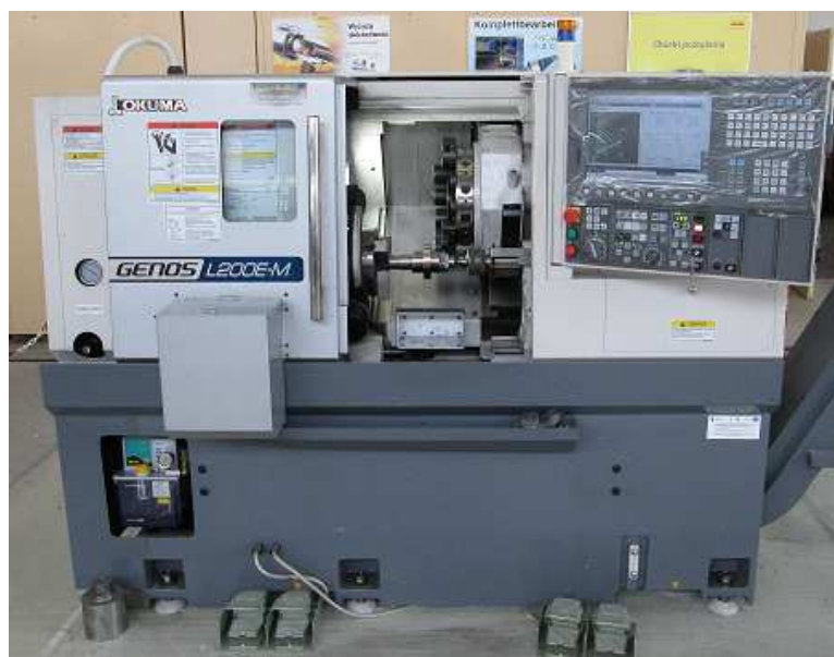
Rys. 4.2. Obrabiarka wielozadaniowa Okuma Genos 200L (maksymalna moc napędu głównego 7,5 kW, maksymalna prędkość obrotowa – 3000 obr/min, zakres ruchów (x, z) – 200x380 mm, magazyn narzędziowy na 12 narzędzi)
