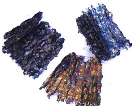
Rys. 5.16. Postać wiórów po skrawaniu ostrzem z CBN ( f=0,04 \text{ mm/obr} )
