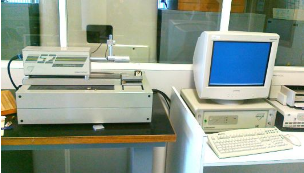
Rys. 4.7. Stanowisko do pomiaru profilu krawędzi ostrza skrawającego
