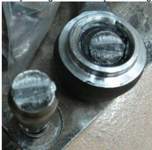
Rys. 4.13. Przykład otrzymanego złomu zmęczeniowego sworznia zwrotnicy przy obciążeniu cyklicznym o amplitudzie F_{za}=60kN
