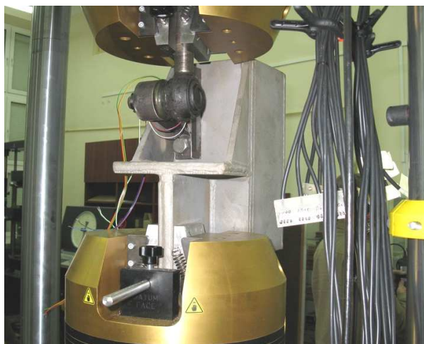
Rys. 4.12. Stanowisko do badań zmęczeniowych zwrotnicy przy obciążeniach cyklicznych
