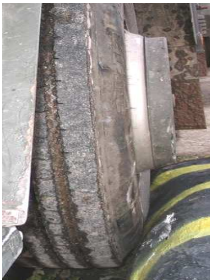
Rys. 4.20. Sposób blokowania skrętu kół przednich w koleinie
