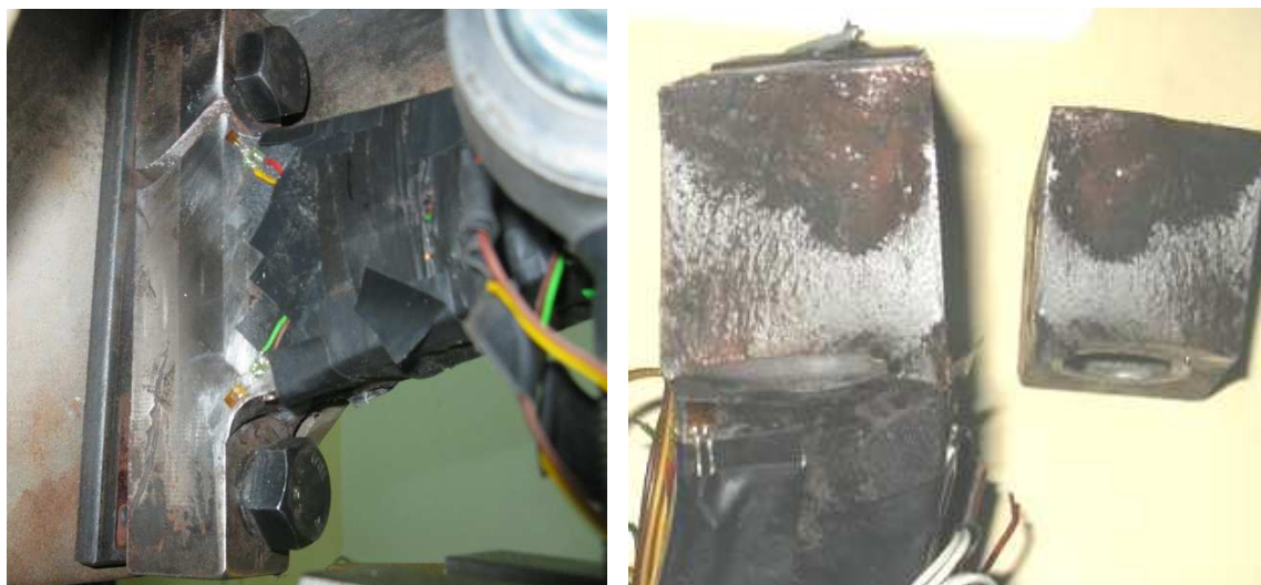
Rys. 4.14. Przykład otrzymanego złomu zmęczeniowego zwrotnicy przy obciążeniu cyklicznym o wartości F_{za}=60kN : a) zwrotnica zamontowana na wsporniku, b) przekrój poprzeczny złomu
