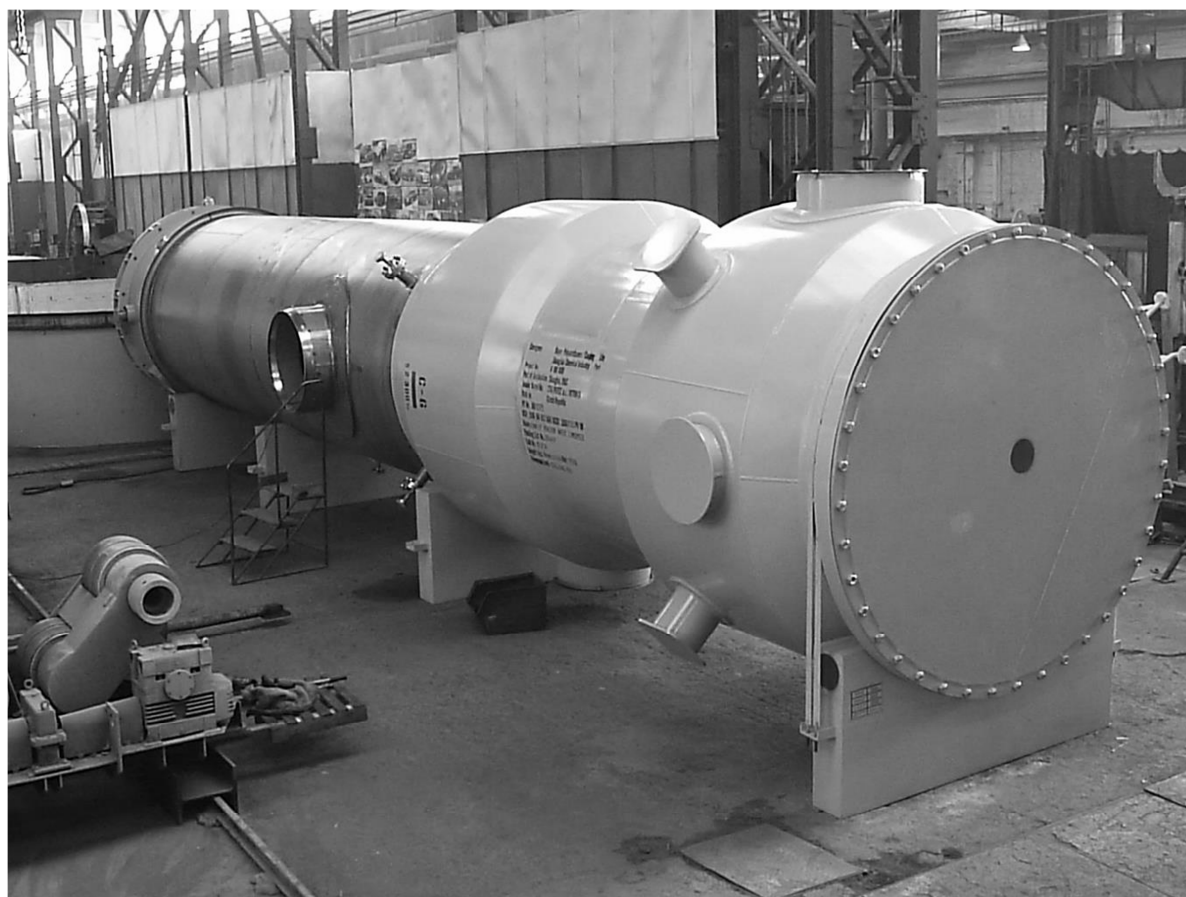
Rys. 5.17. Gotowy wymiennik ciepła- model E109
