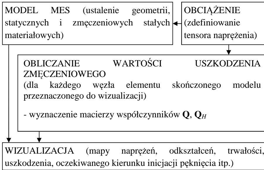
Rys. 6.23. Algorytm wskazujący miejsca inicjacji pęknięć zmęczeniowych
