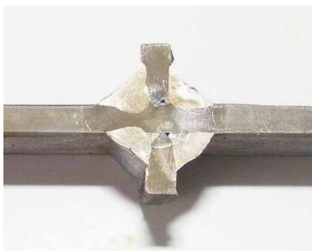
Rys. 4.15. Makrostruktura materiałowa w otoczeniu spoiny bez pełnego przetopu w grani
