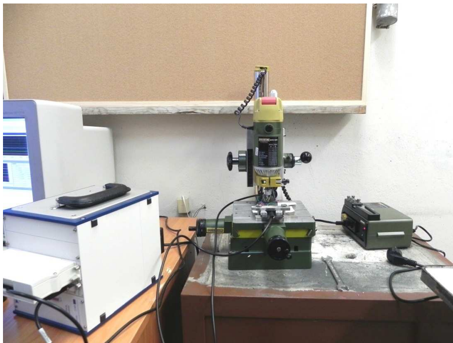
Rys. 4.12. Stanowisko badawcze do wyznaczania naprężeń własnych metodą nawiercania ślepego otworu
