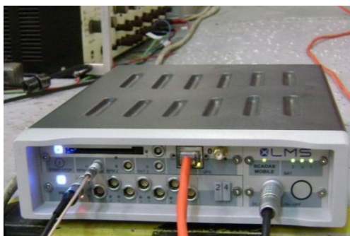
Rys. 4.31. Widok poglądowy zamontowanego na stanowisku badawczym analizatora sygnałów LMS SCADAS Mobile
