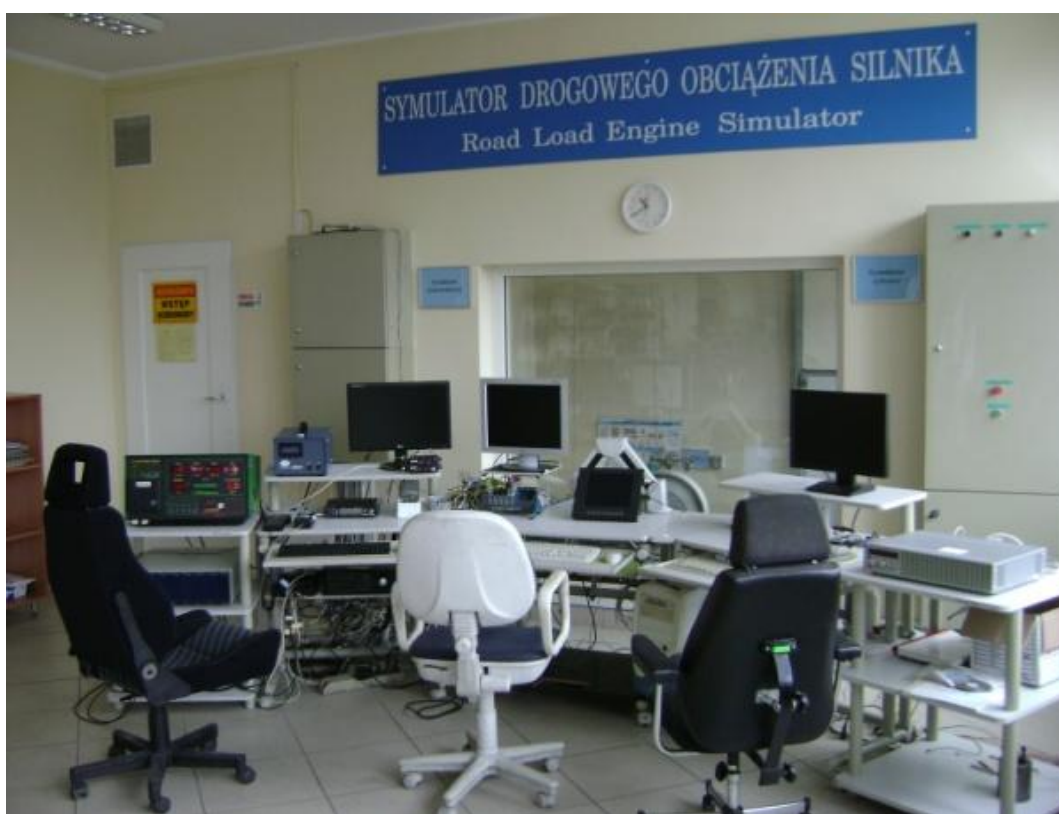
Rys. 4.16. Drugi zespół stanowiska badawczego – panel sterujący do kontroli i rejestracji parametrów testowanego silnika Z-1505
