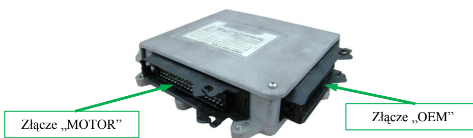
Rys. 4.10. Sterownik silnika ADCIS z oznaczonymi złączami
