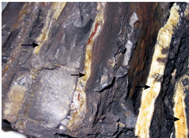
Rysunek 1. Bryłka węgla z widocznymi warstwami organicznej materii inkluzyjnej Figure 1. A coal lump containing some organic inclusions (indicated by arrows)
