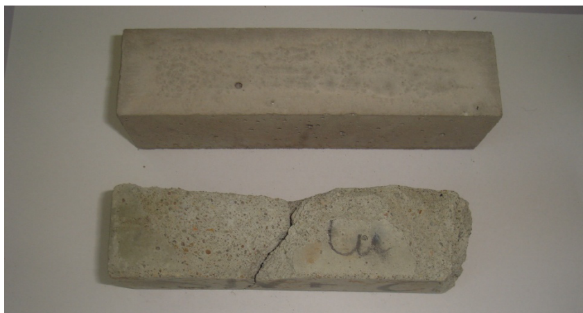
Rys. 6.16. Stan zniszczenia zaprawy IV Cu (dolna próbka) po 360 dniach przechowywania w środowisku wodnym w porównaniu do zaprawy referencyjnej IV (górna próbka) Źródło: badania własne.
