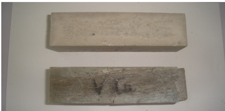
Rys. 6.17. Stan zniszczenia zaprawy V Cu (dolna próbka) po 360 dniach przechowywania w środowisku wodnym w porównaniu do zaprawy referencyjnej V (górna próbka) Źródło: badania własne.
