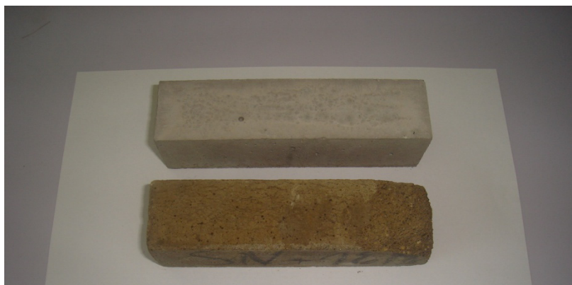
Rys. 6.15. Stan zniszczenia zaprawy IV Mn (dolna próbka) po 360 dniach przechowywania w środowisku wodnym w porównaniu do zaprawy referencyjnej IV (górna próbka) Źródło: badania własne.
