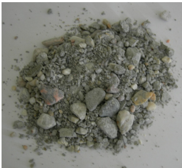
Rys. 7.12. Beton na spoiwie CEM I+40%PF+GO po 300 cyklach zamrażania i odmrażania. Źródło: badania własne.
