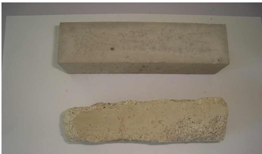
Rys. 6.18. Stan zniszczenia zaprawy IV Pb (dolna próbka) po 360 dniach przechowywania w środowisku wodnym w porównaniu do zaprawy referencyjnej IV (górna próbka) Źródło: badania własne.
