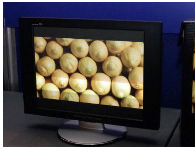
Rys. 4. Prototypowy wyświetlacz FED firmy Sony[8] Fig. 4. The prototype display FED Sony[8]
