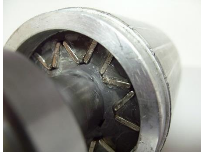
Rys. 1.2.3. Wirnik nr 2 – rozmieszczenie magnesów w układzie VV
