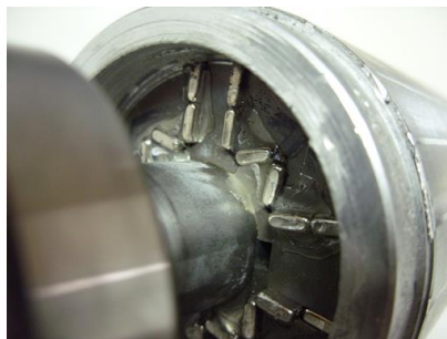
Rys. 1.2.2. Wirnik nr 1 – rozmieszczenie magnesów w układzie W
