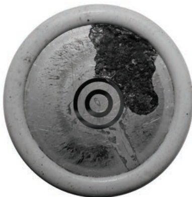
Rys. 12. Uszkodzona płytkę krzemowa tyrystora
