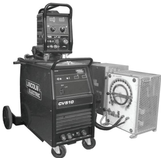
Rys. 5. Badane urządzenie spawalnicze obciążone opornicą
