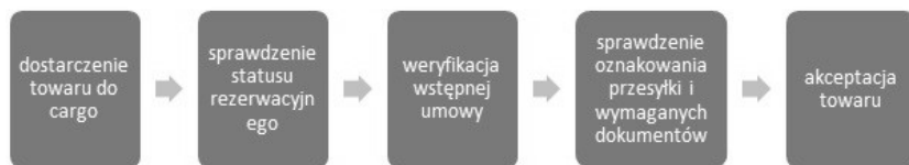
Rys. 3. Schemat procesu akceptacji towaru do przewozu
