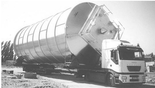
Rys. 5. Transport zbiorników chemicznych o długości 28m i średnicy 8,1 m przez przedsiębiorstwo Panas Transport.
