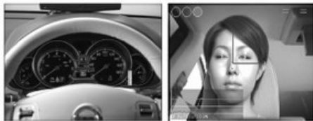
Rys. 7. Kamera wykrywająca mimikę twarzy oraz przykładowy obraz z kamery
