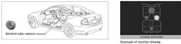
Rys. 6. Czujnik stężenia alkoholu oraz przykładowy komunikat wyświetlający się na monitorze systemu
