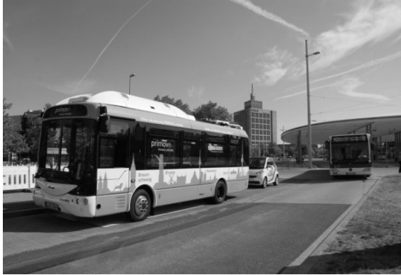
Rys. 7. „Laborbus” Bombardiera w trakcie prac testowych na zamontowanej przy kolejowym Dworcu Głównym indukcyjnej płycie ładującej (źródło: http://www.verkehr-bs.de/ ; dostęp 26.10.2014)
