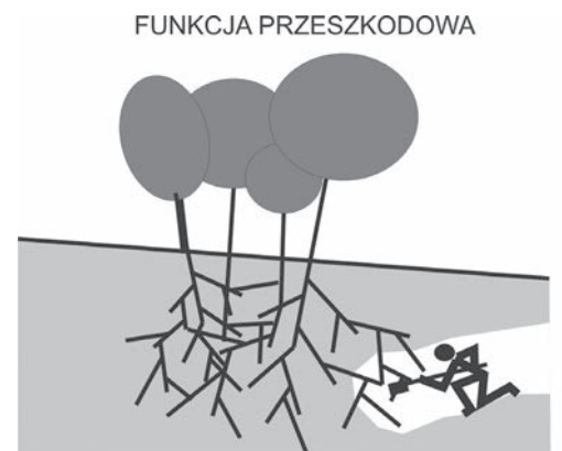
PRZESKODA W PRACACH PODZIEMNYCH
