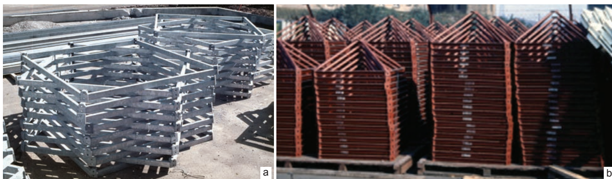
II. 5. Komponenty przemysłowe: a) elementy warstwy dolnej, b) piramidy tworzące warstwę górną i środkową (fot. R. Motro)
