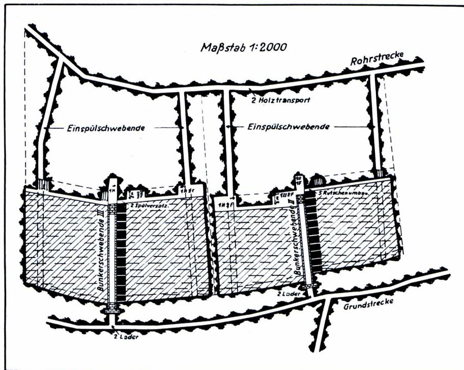
wird mit dem Abbau aus der Mitte zwischen den zwei Schwebenden nach diesen hin begonnen. Man bildet so einen 100 — 220 m langen Abbaustoß. In der Mitte spart man eine Bunkerschwebende in Beton aus. (Bild 35.)
