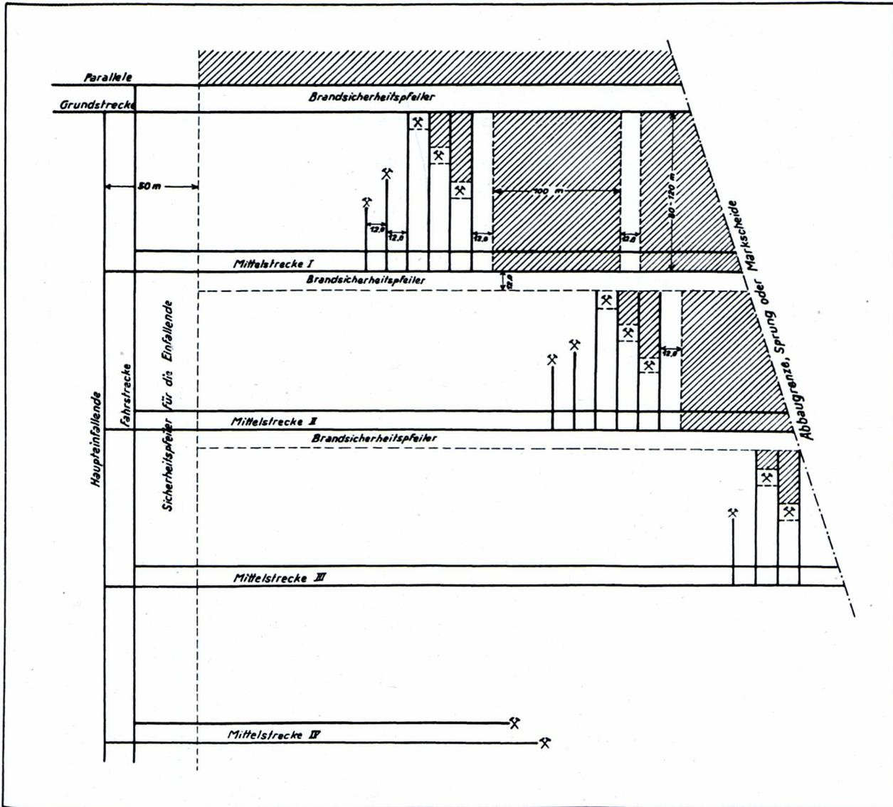
Das Auskohlen dauert bei zweischichtiger Belegung 12 Tage. Nach Beendigung wird zunächst das gegen den Alten Mann stehengebliebene Bein schwebend nach Möglichkeit gebaut. Anschließend wird der Pfeiler weitmöglichst ausgeraubt und zu Bruch geworfen. Der Holzverbrauch beträgt 1,1 cbm je 100 to Förderung.
