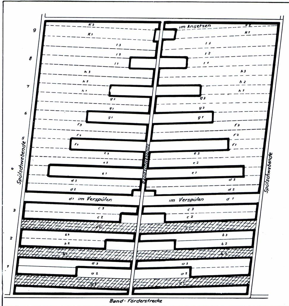
In jedem Unterabschnitt kann ein Stoß, d. h. in der ganzen Schwebenden von 250 m Höhe oder auf 500 m Abbaufrent können bestenfalls 20 Stöße belegt werden. In der Tat werden aber nur 16 Stoßbaue belegt, da für die Zeit des Verspülens eines Stoßes die Belegschaft in einen anderen sogenannten Springstoß wechseln muß. Diese 16 Stöße sind dauernd in Förderung, die übrigen beim Verspülen und Ansetzen.
