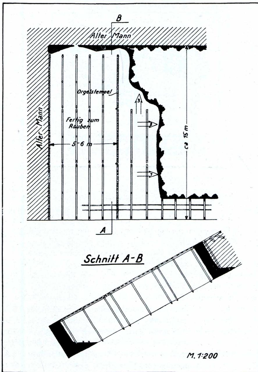
Gefördert werden aus diesem Baufeld täglich in 2 Schichten 230 bis 250 to mit einer Leistung von 3 bis 4 to je Mann und Schicht. Hierbei fallen bis 40 % Vorrichtungskohle.
