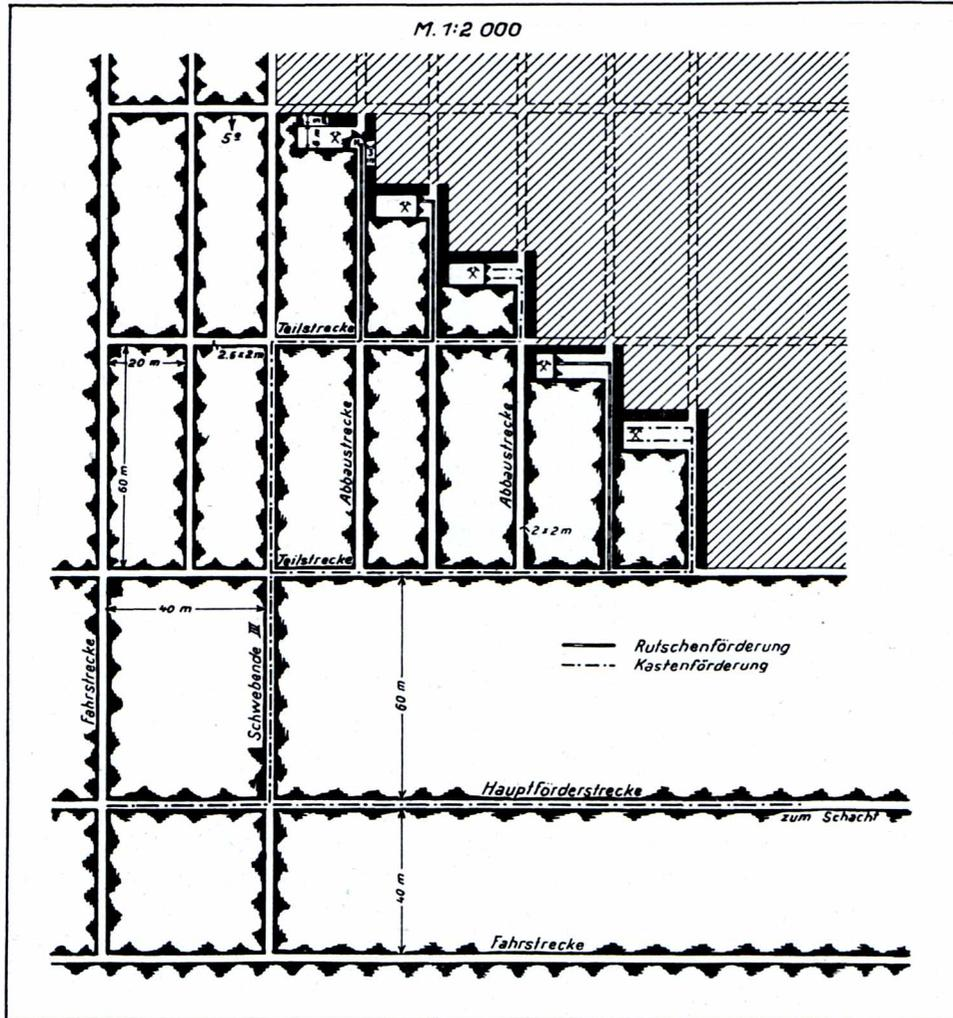
rd. 1,30 fm je 100 to Förderung. Die hereingewonnene Kohle wird entweder im Abbau unmittelbar in Förderwagen gefüllt, die zur Teilstrecke abgebremst werden, oder sie wird durch Rutschen in den Abbauschwebenden zur Teilstrecke befördert, wo das Umladen in Förderwagen erfolgt.
