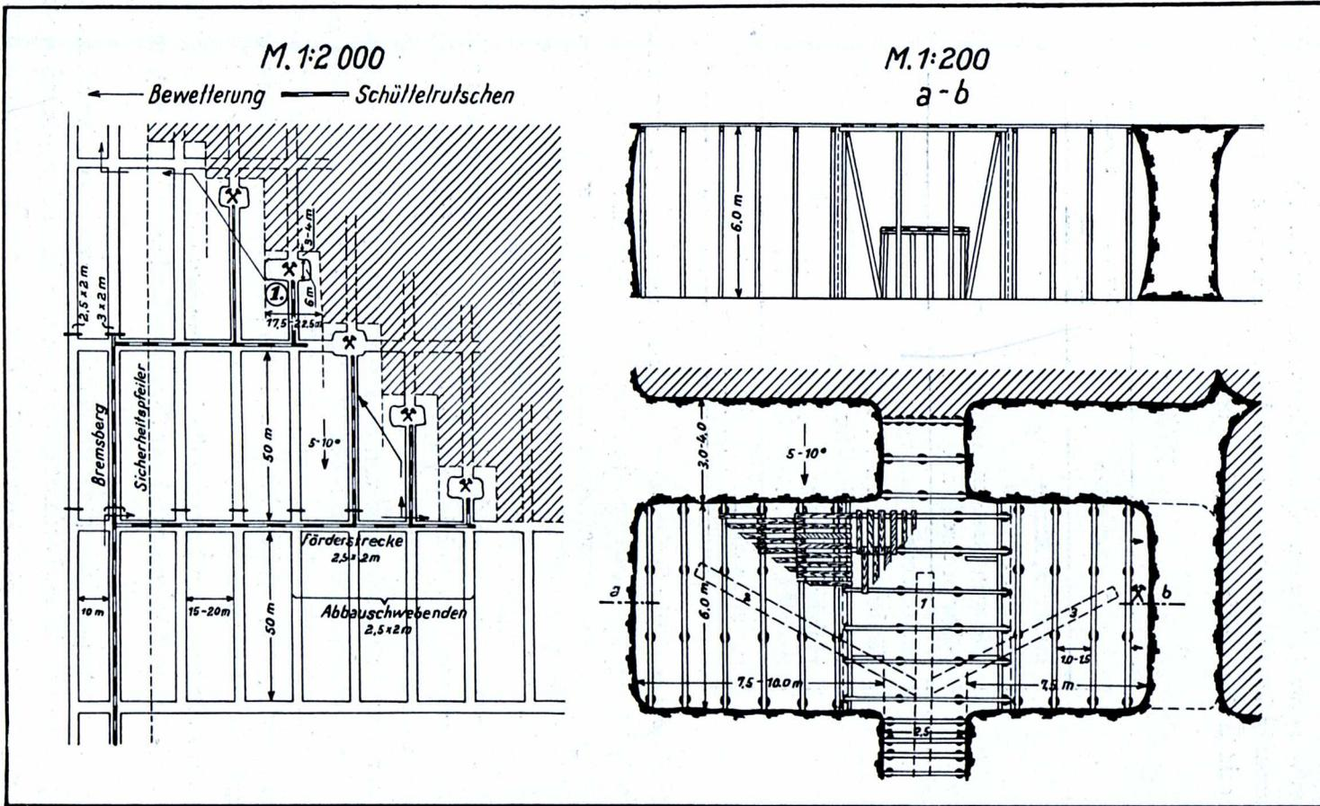
Das Auskohlen und Zubruchwerfen eines Pfeilers von 20 × 50 m dauert 4 Monate, der Abbau einer normalen Bauabteilung 12 Monate. Je 1000 to Förderung sind innerhalb der Bauabteilungen 120 m Abbaustoß und 2250 m Strecken notwendig.
