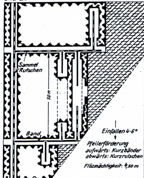
In einer Abbaubteilung sind bis zu drei schwebende und drei einfallende Kammern belegt, von denen vier in voller Förderung in der Schicht je 45 to bringen, während zwei angesetzt bzw. hochgebrochen werden mit einer Förderung von je 10 to in der Schicht. Weiter werden zwei Beine gegen die vorhergegangene Kammer hereingewonnen und in einer Abbaustrecke die an dieser stehengebliebenen Beine (siehe Bild 21). Aus diesen Betrieben fallen
