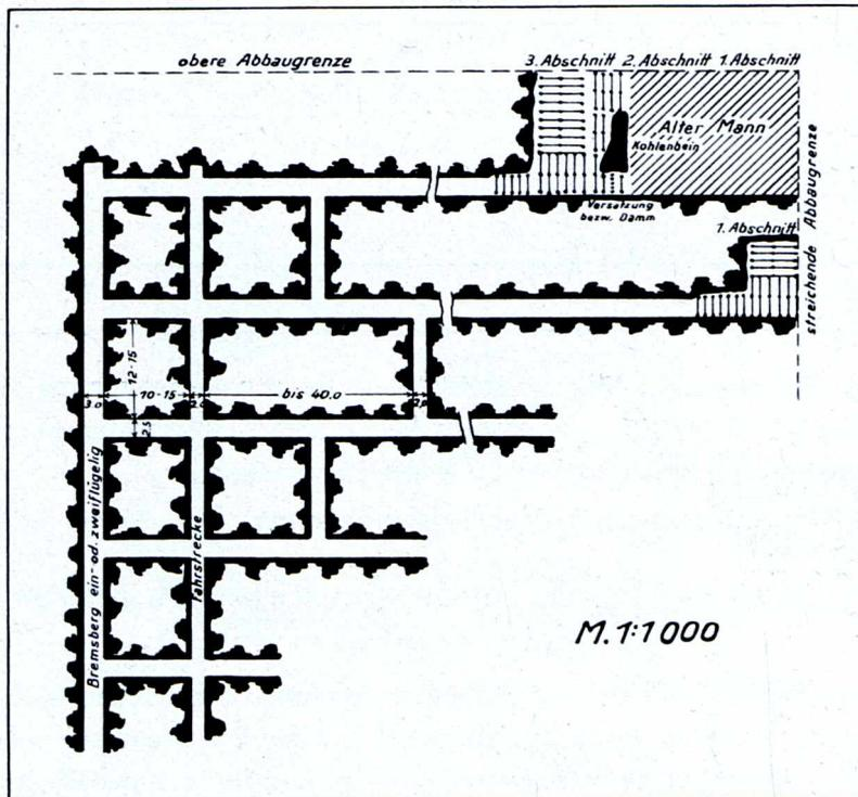
strecken sind selbsttätige Bremsberge eingerichtet. Erst neuerdings ist man dazu übergegangen, bei größerer Förderung aus einem Baufeld die Wagenförderung durch Schüttelrutschen zu ersetzen und diese auch in die Abbaue zu ziehen.
