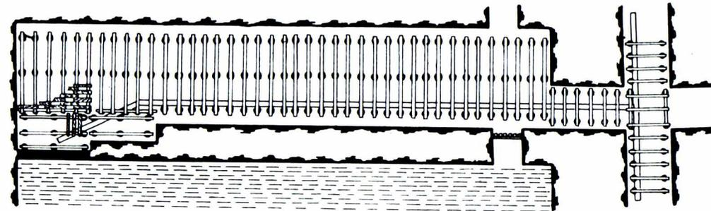
im oberen Teile der Schwebenden sind Hängerutschen, im unteren Teil der Hauptschwebenden wird wegen der größeren Förderleistung Gummiförderband verwendet.
