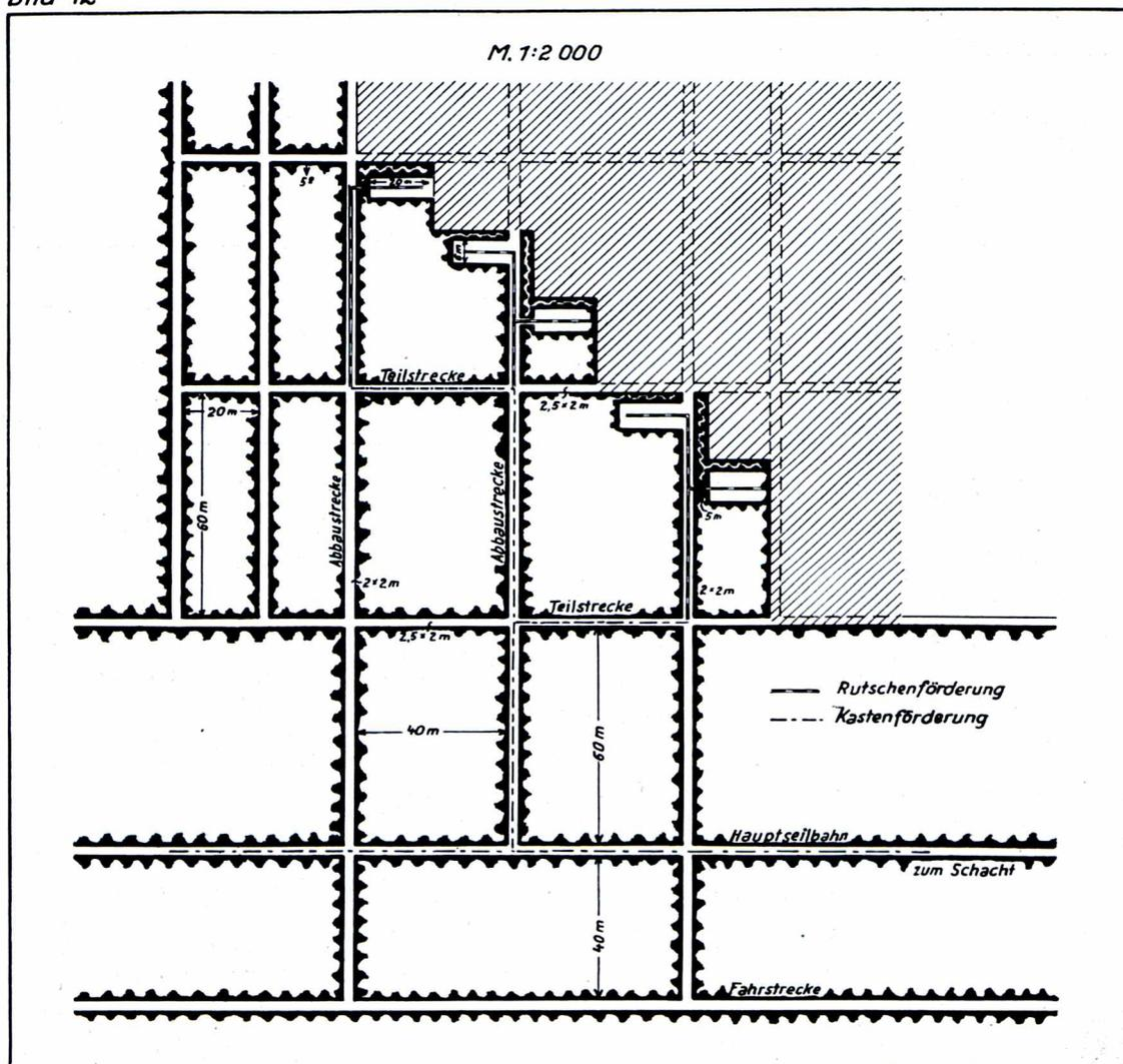
Man läßt bei dem rechten Pfeiler einer jeden Schwebenden, der gegen den linken etwa 10 m vorseilt, gegen die Abbaustrecke zunächst ein etwa 5 m starkes Kohlenbein anstehen, das dann später beim Auskohlen des linken Pfeilers möglichst hereingewonnen wird. Jeder Pfeiler ist 20 m lang und 6 m breit und braucht zum Auskohlen einschließlich der
