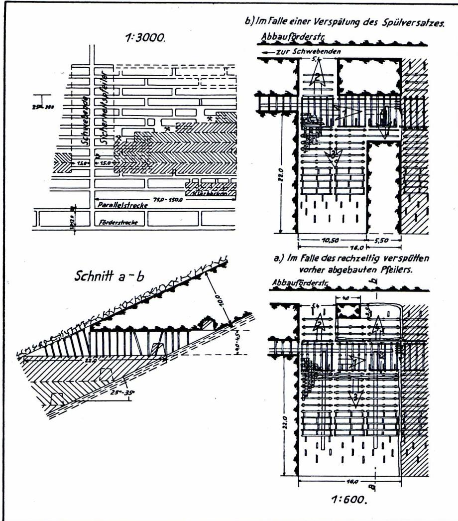
Der Abbau der Kohle erfolgt 100 % ig. Nach Beendigung des Auskohlens wird der Abbau vollständig verspült. Die Rohrstrecke zum Zuführen des Spülversatzmaterials ist auf dem Liegenden unmittelbar über der im Abbau befindlichen Scheibe aufgefahren und dient später als Abbaustrecke für die nächste Scheibe. Ein Spüldamm ist nur in der Abbaustrecke notwendig. Der Holzverbrauch beträgt 1,80 cbm je 100 to Förderung, der Sprengstoffverbrauch 110 gr.
