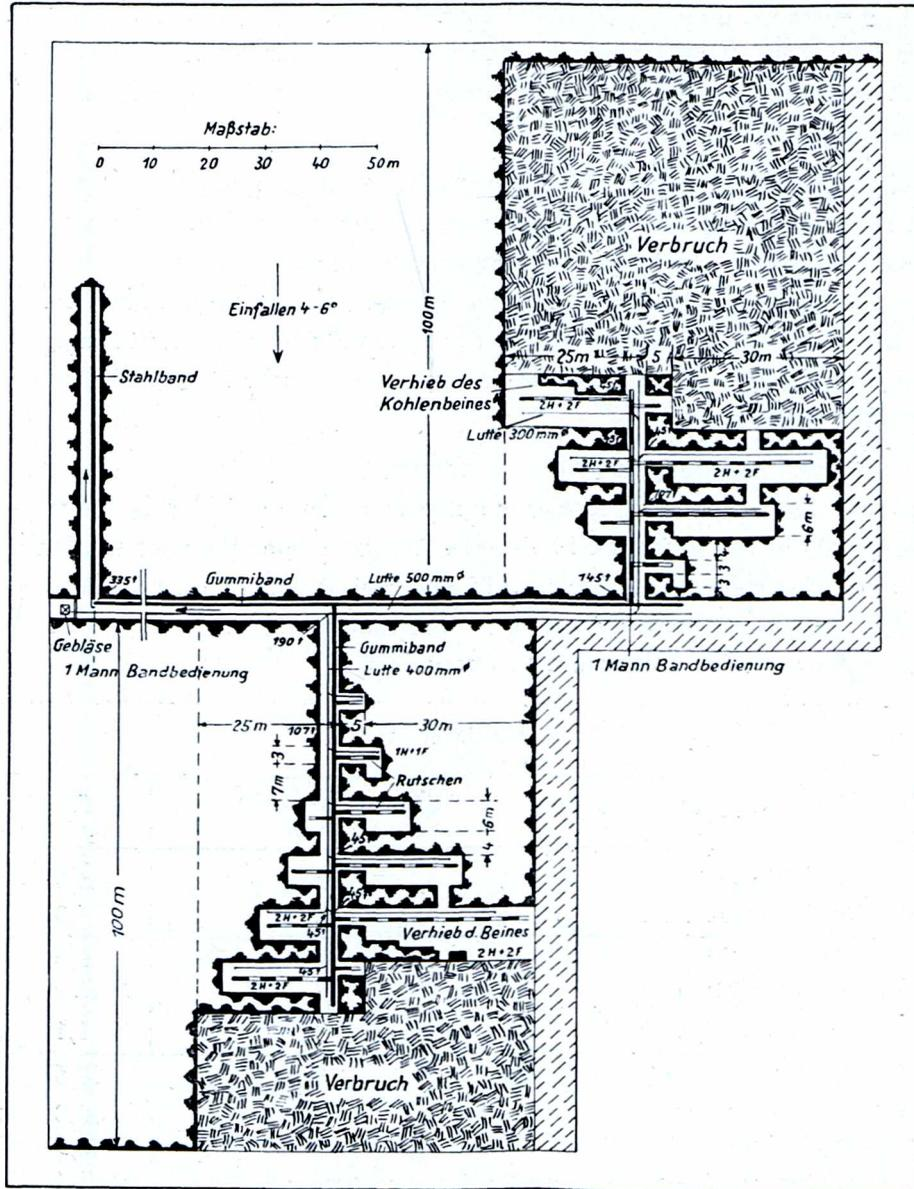
Oberhalb der Abbaustrecke erfolgt der Abbau von oben nach unten, und unterhalb dieser von unten nach oben. Auf jedem Flügel sind 2 — 3 Kammern belegt, sodaß jede Schwebende oder Einfallende 4 — 5 Abbaue aufweist. Die Kohlegewinnung erfolgt von Hand
