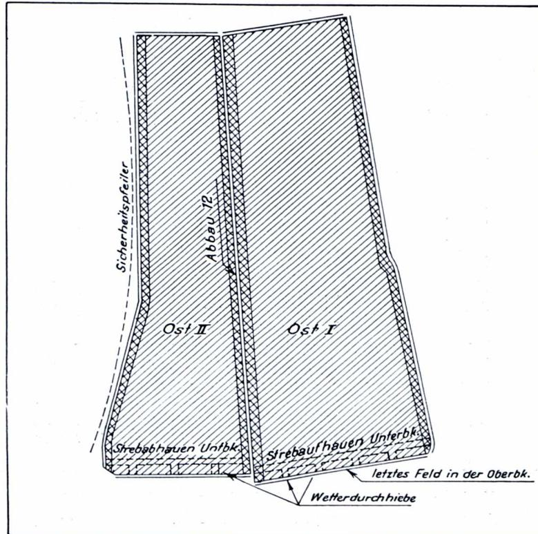
des letzten Feldes in der oberen Scheibe wird absatzweise geraubt. Das geraubte Strebeisen wird für das Auffahren des Strebaufhauens in der unteren Scheibe verwendet. Der Vortrieb des Strebaufhauens erfolgt mittels Großschrämmaschine.
