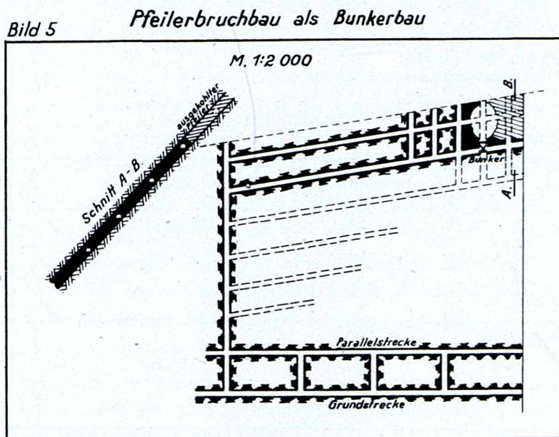
gut ausgebauten Abbaustrecke. Daher sind Unfälle durch Stein- und Kohlenfall trotz des mächtigen Flözes, des steilen Einfallens und des großen Abbauraumes, der vollständig ohne Ausbau gelassen wird, fast unbekannt. Der hangende Sandstein bricht meist bald nach dem Auskohlen eines Pfeilers herein.
