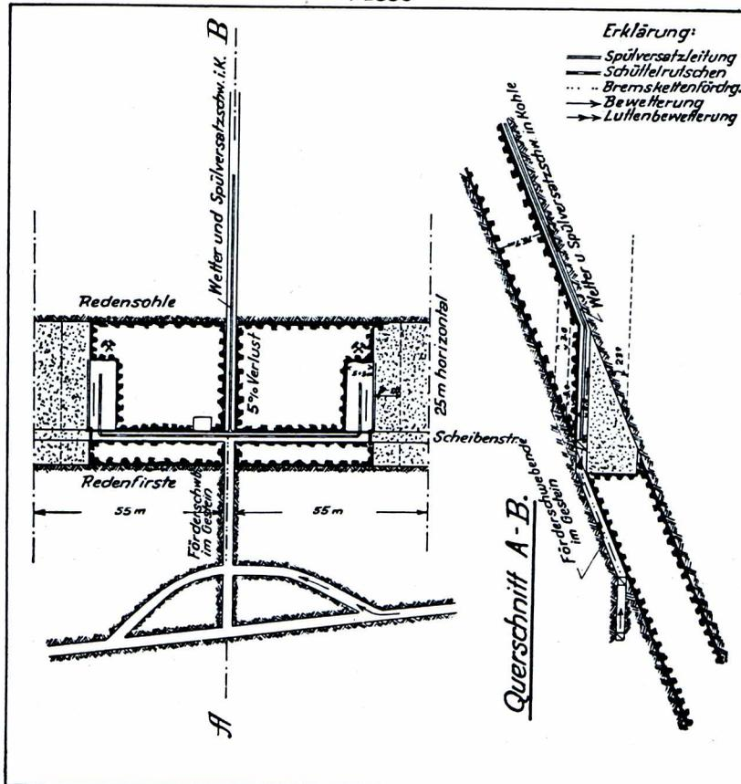
Die täglich verfahrenen Schichten bei diesem Abbauverfahren sind je 100 to Förderung die der Zahlentafel 37.
