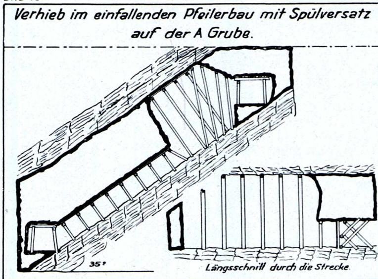
Beim Herstellen der Durchhiebe ist eine Verwendung von Schrä- oder Kerbmaschinen nicht möglich, da die Kohle hierfür nicht hart genug und zu klüftig, und das Einfallen zu steil ist.
