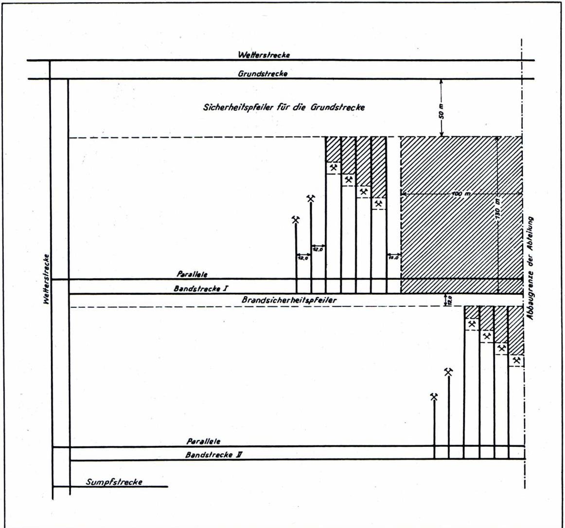
fallen also 25 % Vorrichtungskohle an. Das Bild 9 zeigt eine Bauabteilung mit zwei derartigen Mittelstrecken und einer weiteren in der Entwicklung befindlichen mit zwei Pfeilerabbauen und einem Streckenvortrieb, sodaß in der ganzen Bauabteilung also 8 Pfeilerabbau und 4 — 5 Streckenvortriebe belegt sind. Gleichzeitig wird schon eine vierte Mittelstrecke mit Parallelstrecke aufgefahren. Die Tagesförderung einer derartigen Abbaubteilung mit
