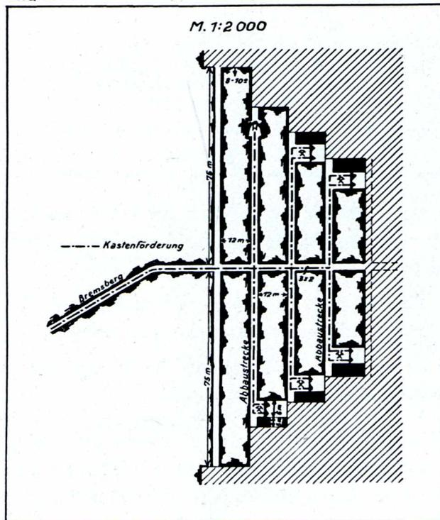
sind in diagonaler Richtung auf lange Front gesetzt. Die Gebirgsverhältnisse erlauben, daß auf jedem Flügel je 3 Abbaue belegt werden. Da das Schieferhangende gut hereinbricht, findet eine sofortige Entspannung des Gebirges und eine Neuverlagerung auf der Sohle des Flözes statt.
