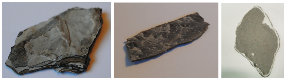
Rys. 1. Osad porastający ścianki basenu pulpy i rurociągu
