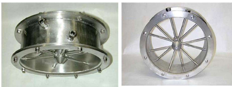
Rys. 7. Siatka spiętrząca do pomiaru strumienia objętości spalin
