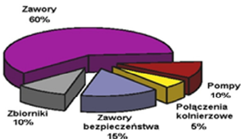
Rys. 1. Procentowe udziały wycieku w urządzeniach stosowanych w rafineriach
