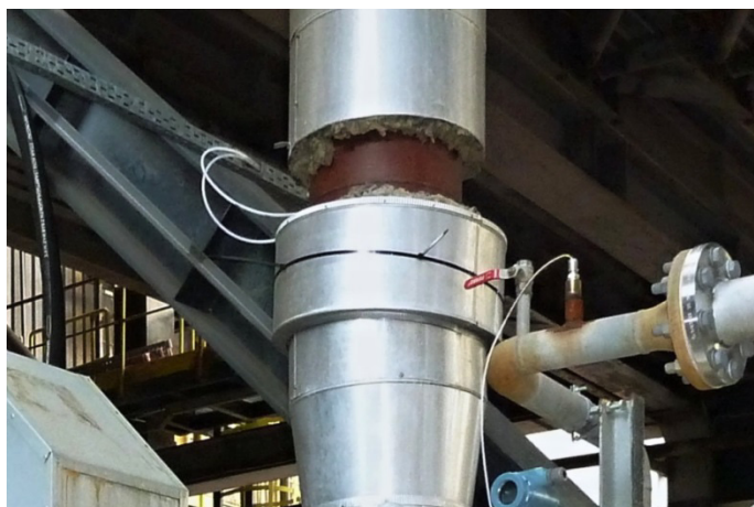
Rys. 8. Widok zamontowanej w instalacji pilotowej siatki spiętrzającej
