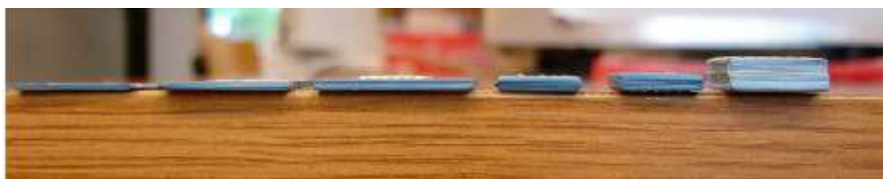
Rys. 6.1. Wykonane podłoża o grubości 1 do 5,3 mm
