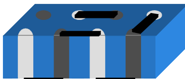
Rys. 5.4. Koncepcja termostosu w topologii via
