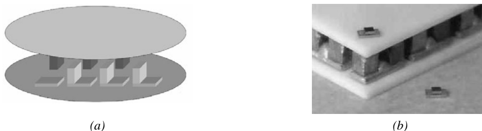
Rys. 3.14. a) Budowa modułu Peltiera; b) zdjęcie modułu Peltiera [112,161]
