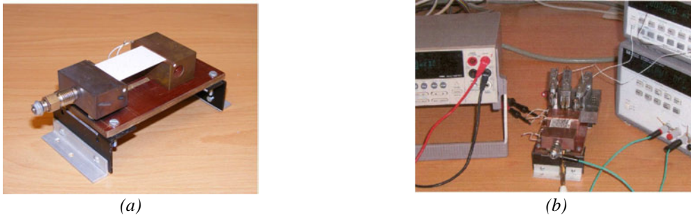
Rys. 4.6. a) Stolik pomiarowy z grzejnikiem i radiatorem; b) stanowisko pomiarowe z oprzyrządowaniem
