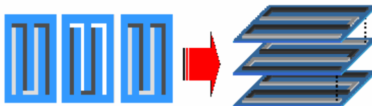
Rys. 5.3. Koncepcja termostosu w topologii kanapkowej .
