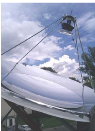
Rys. 3. Koncentrator promieniowania słonecznego z ogniwem fotowoltaicznym
