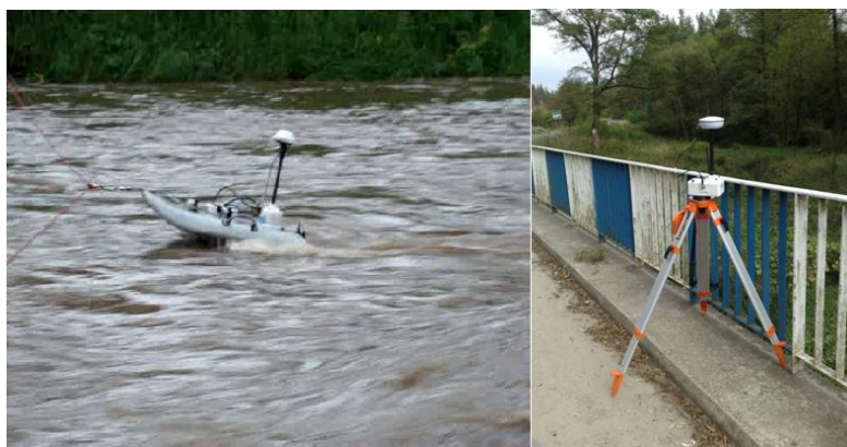
Rys. 8. Miernik ADCP na pływaku podczas pomiaru na rzece oraz zestaw pozycjonujący RTK DGPS
