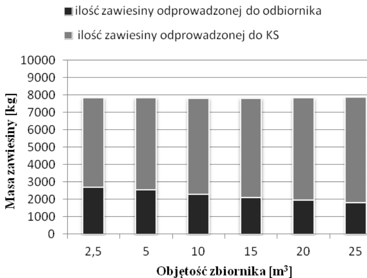
Rys. 5. Masa zawiesiny odprowadzanej do kanalizacji ściekowej i do odbiornika w zależności od objętości zbiornika retencyjnego w przeliczeniu na 1 ha powierzchni uszczelnionej - w 2012 roku
