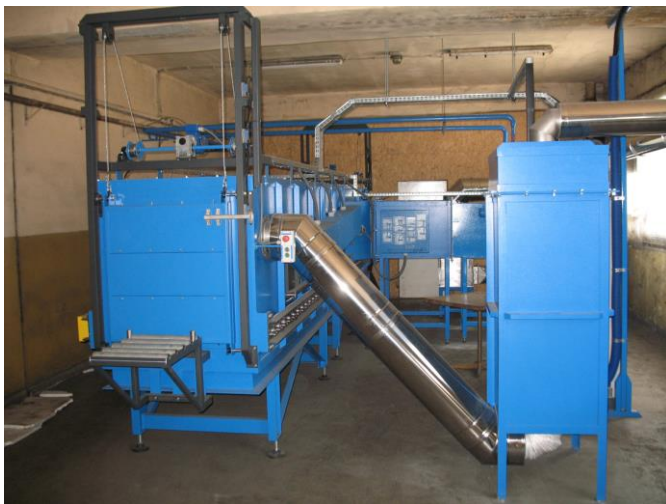
Rys. 2. Instalacja doświadczalna do termicznego unieszkodliwiania odpadów garbarskich
