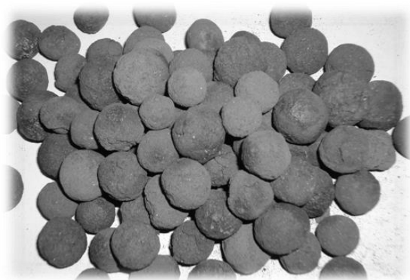
Rys. 2. Granulat typu LECA stanowiący wypełnienie filtrów
