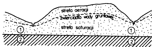
Rys. 2.9. Strefa saturacji i aeracji: 1 – warstwa przepuszczalna (wodonośna), 2 – warstwa nieprzepuszczalna
