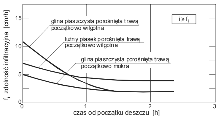
Rys. 2.47. Zdolność infiltracyjna gleb w zależności od czasu trwania opadu (wg S.S. Butlera), i – natężenie deszczu
