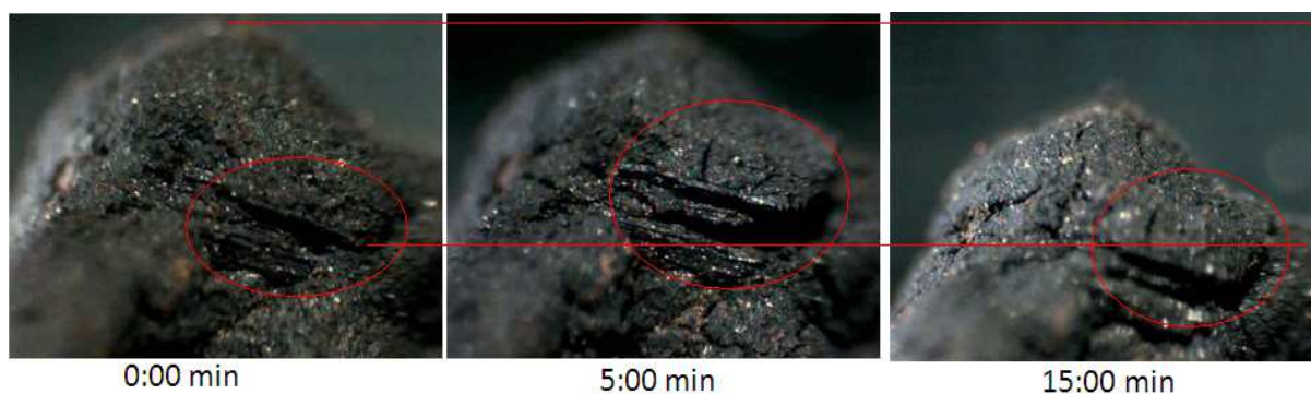
Rysunek 48. Węgiel z Bełchatowa, ziarno 2,0mm, temperatura suszenia 70°C, czas suszenia 15:00 min, powiększenie x20
