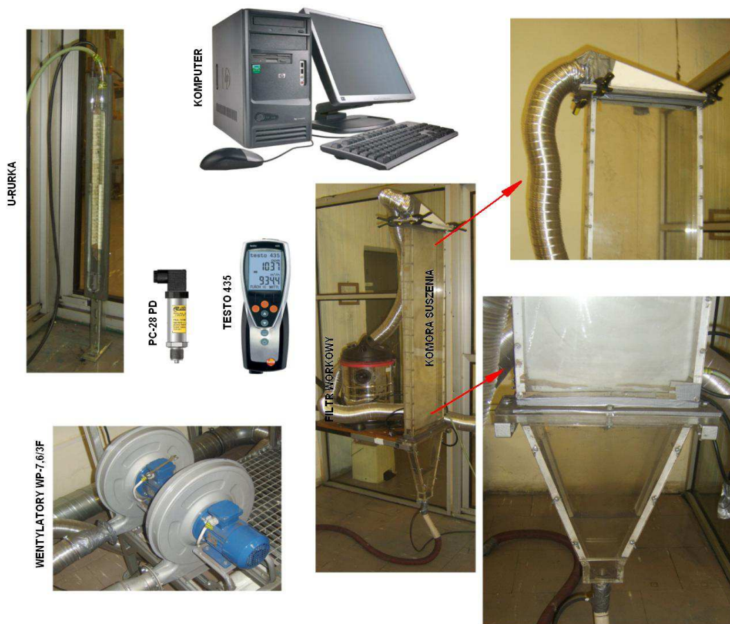
Rysunek 57. Zdjęcia suszarki fluidalnej pęcherzykowej wraz z aparaturą pomiarową
