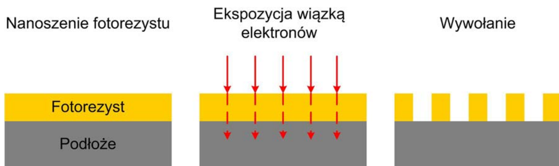
Rys. 2.18 Koncepcja wytwarzania nanometrowych wzorów za pomocą elektronolitografii.
