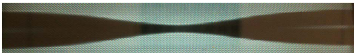
Rys. 5.10 Proces wytwarzania tapera światłowodowego obserwowany na wyświetlaczu spawarki elektrycznej.
