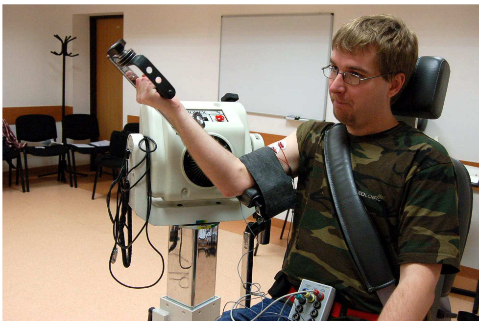
Rysunek 3.4: Pomiar generowanego momentu siły w warunkach dynamicznych
