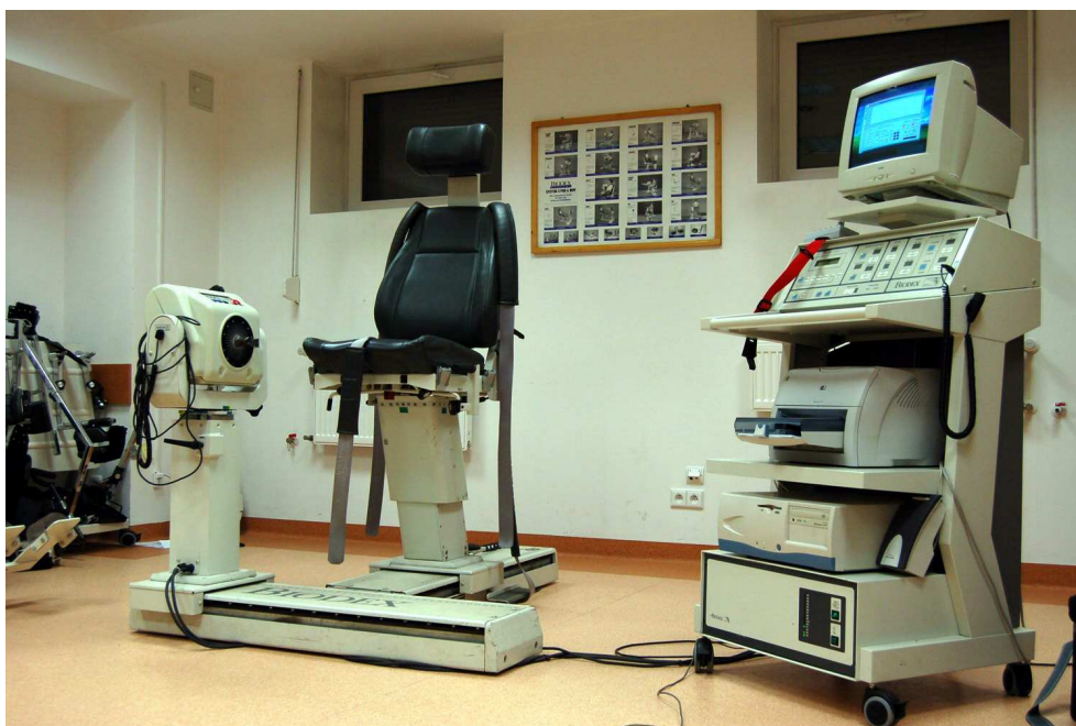
Rysunek 3.2: Stanowisko do pomiaru momentów sił (Katedra Fizjoterapii w Medycynie Zachowawczej i Zabiegowej Akademii Wychowania Fizycznego we Wrocławiu)
