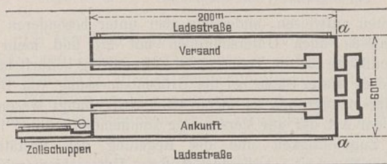
Abb. 14. Güterschuppen mit innerem Ladegleis in Hannover.
