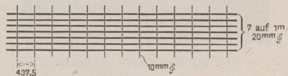
Abb. 19. Eiseneinlage am Brückenkanal.
