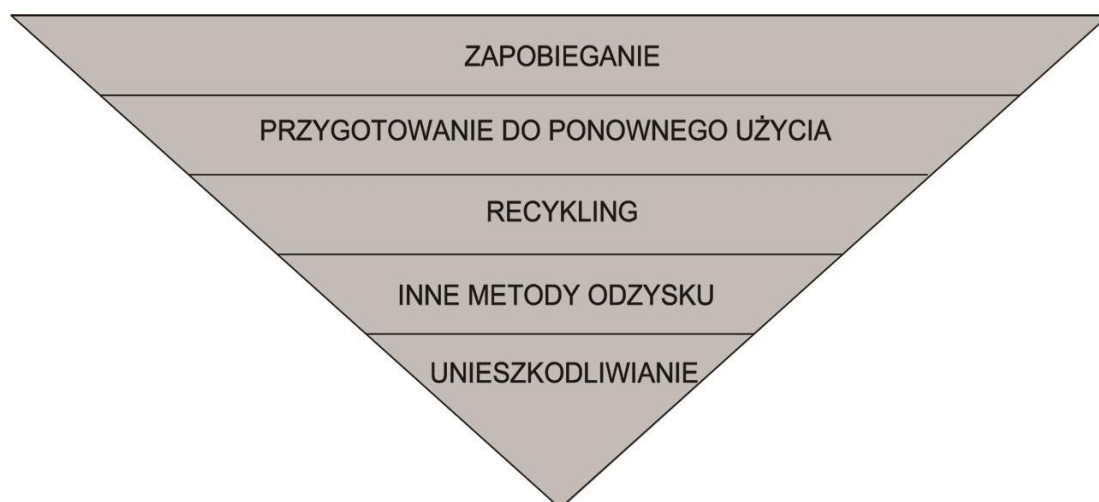
Rys. 17. Hierarchia postępowania z odpadami zgodna z dyrektywą Parlamentu Europejskiego z dnia 19. 11. 2008. Opracowanie autora na podstawie [49].
