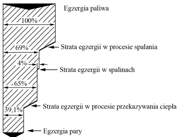
Rys. 12.6. Straty egzergii w kotle parowym
