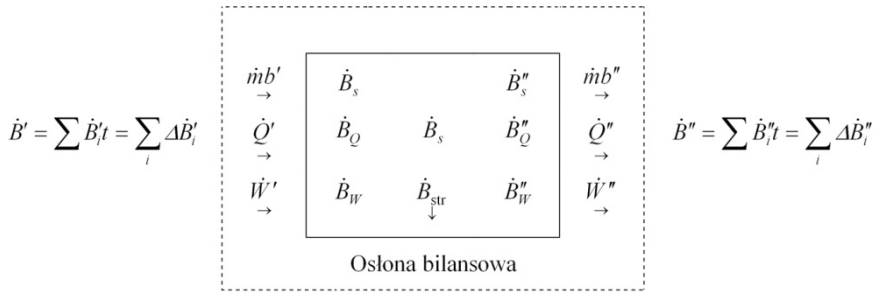
Rys. 17.1. Schemat bilansu egzergii dla systemu termodynamicznego
