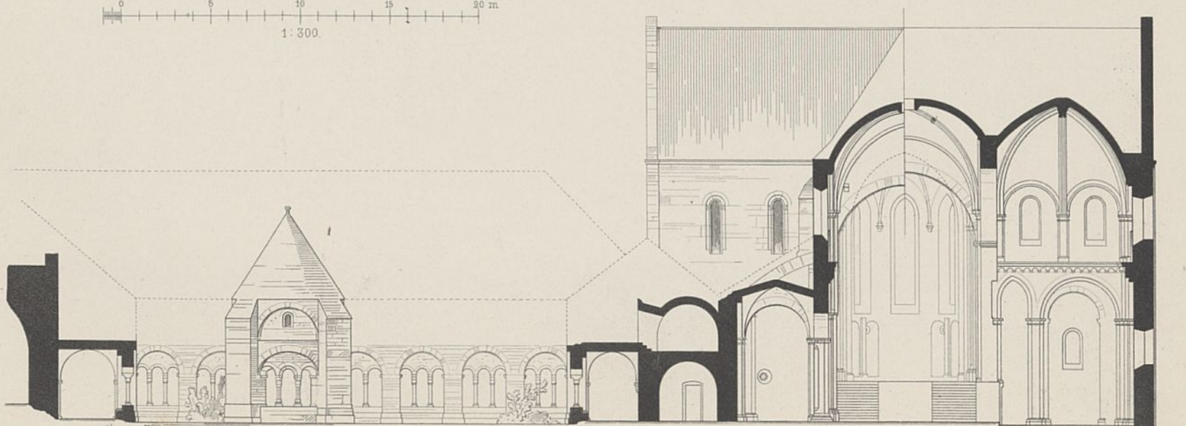
Abb. 3. Schnitt durch den Kreuzgang und die Kirche.
