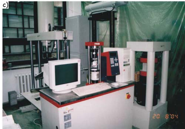
Fot. 3.1. Zestaw maszyn do badań wytrzymałości: a) prasa ZD-10/90 o zakresie 100 kN, z rejestracją przemieszczeń typu x-y; b) prasa EDT-1600 o zakresie 1600 kN z automatyką i regulacją przyrostu siły; c) zestaw trzech maszyn wytrzymałościowych TONI TECHNIK, sterowanych komputerowo o zakresach: 10 kN, 100 kN i 3000 kN
