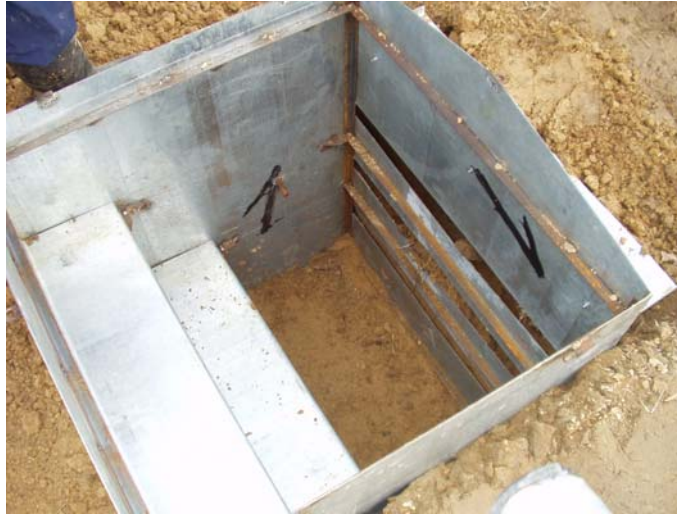
Fot. 1. Widok chwytacza odpływu w trakcie instalacji – w widocznych otworach zainstalowane zostały poziome przegrody zbierające odpływ z poszczególnych warstw (fot. autor) Photo 1. Runoff trap installation – horizontal screens for interflow capturing would be mounted in indicated wholes (photo author)
