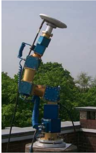
Rys. 4.4. Robot do bezwzględnej kalibracji anten GPS (Wübbena et al., 2000)
