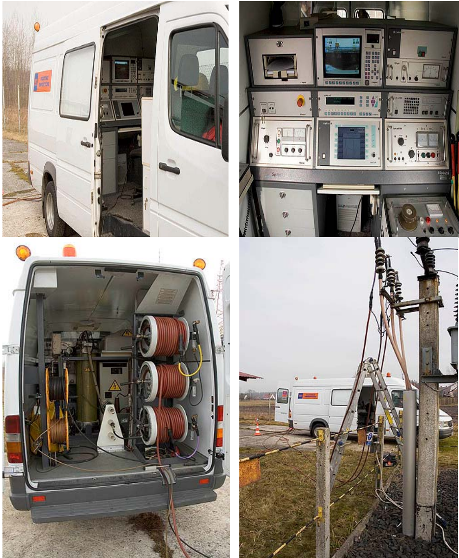
Rys. 3.19. Widok ogólny wyposażenia specjalistycznego samochodu pomiarowego użytego do lokalizacji miejsca uszkodzenia linii kablowej; podstawowe wyposażenie: generator udarowy i mikroprocesorowe urządzenie pomiarowe, sprzężone z rejestratorem reflektogramów
