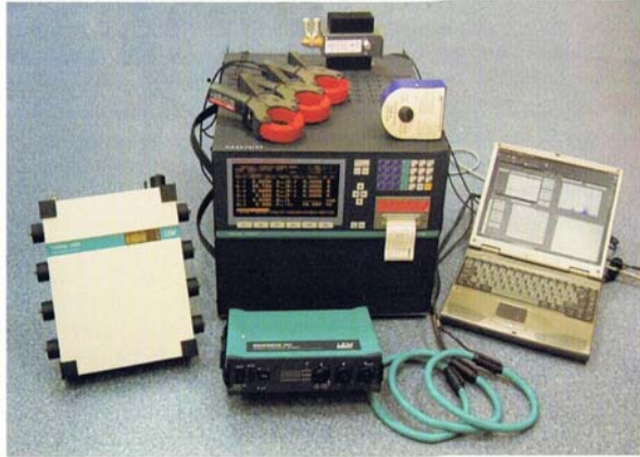
Rys. 3.1. Ogólny widok analizatora jakości energii elektrycznej typu MEMOBOX 800 firmy LEM
