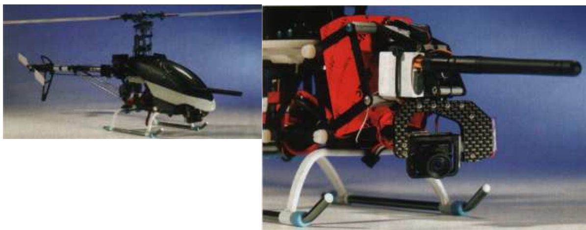
Zdj. 8. Z lewej: like 90, z prawej: przód like'a 90 z kamerą osadzoną na obrotowym ramieniu.
