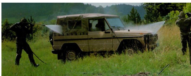
Zdj. 1. Pierwszy etap - zmywanie wstępne zanieczyszczeń z pojazdów, realizowane jest zwartym strumieniem zimnej wody przy pomocy jednej lub dwóch lanc
