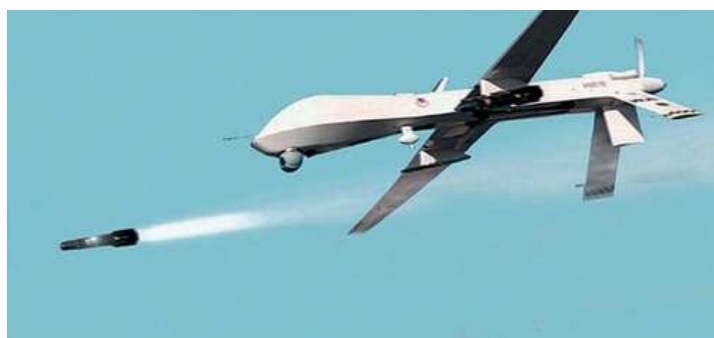
Zdj. 2. Odpalenie pocisku przeciwpancernego AGM-114 Hellfire z Predatora MQ-1B podczas prób przed użyciem operacyjnym takiej konfiguracji w misjach antyterrorystycznych na Bliskim Wschodzie
