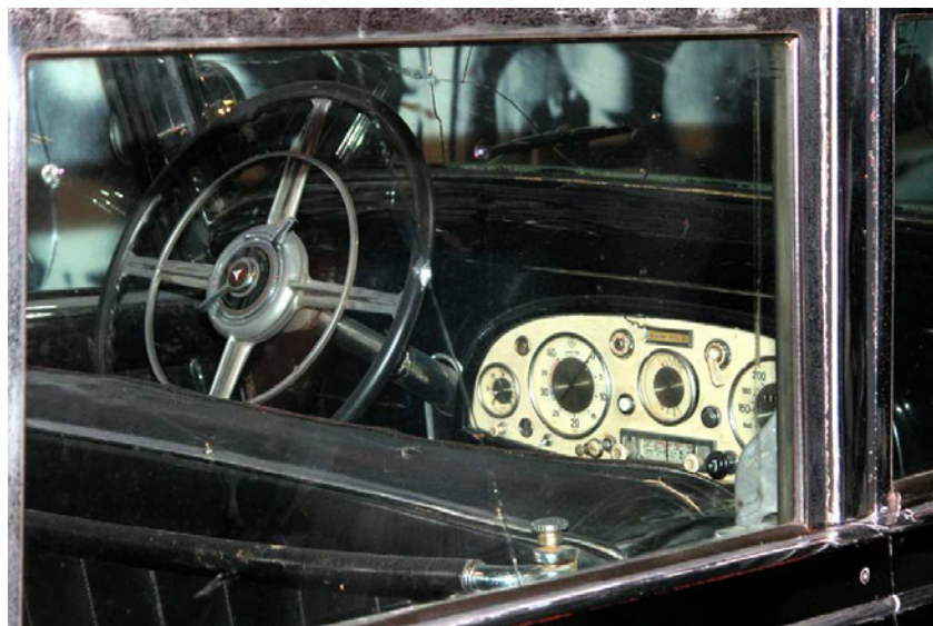
Zdj. 1. Mercedes-Benz model 770-K z widocznym fragmentem szyby kuloodpornej i siłownika wspomagającego otwieranie drzwi
