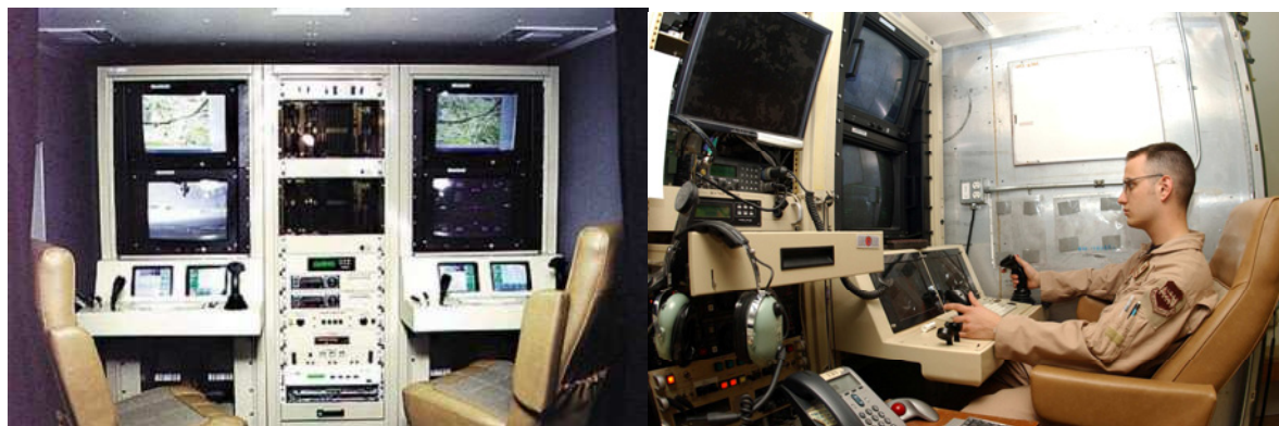
Zdj. 1. Wnętrze naziemnej stacji kontroli lotu Predatora (Ground Control Station)
