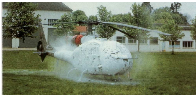
Zdj. 3. Trzeci etap - reakcja środka do likwidacji skażeń z substancjami skażającymi, czas 10 -30'
