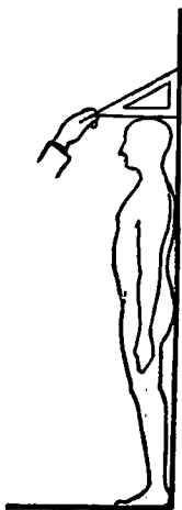
Ryc. 4. Pomiar wysokości z pomocą podziałki na ścianie i trójkąta rysunkowego.
