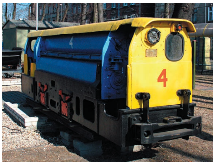
Ryc. 3. Lokomotywa pneumatyczna firmy Jung
