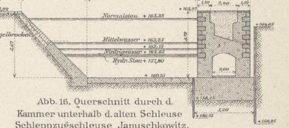
Abb. 16. Querschnitt durch d. Kammer unterhalb d. alten Schleuse Schleppzugschleuse Januschkowitz.
