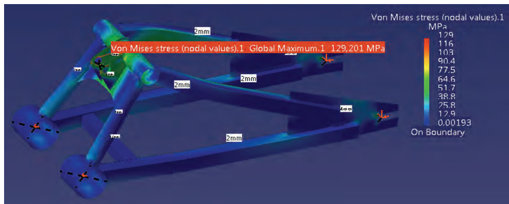
Rys. 6. Analiza wahacza LEMa Napoli
