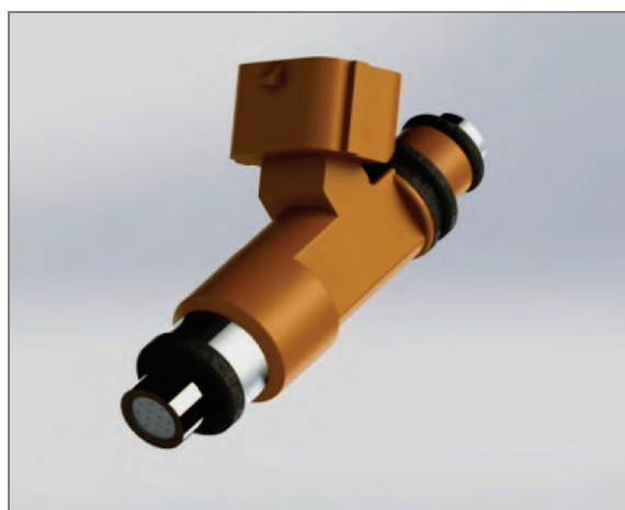
Rys. 4. Wtryskiwacz benzynowy pojazdu CMS-03
