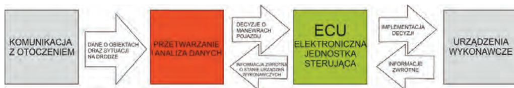
Rys. 2. Schemat przepływu danych między systemem komunikacji z otoczeniem a urządzeniami wykonawczymi
