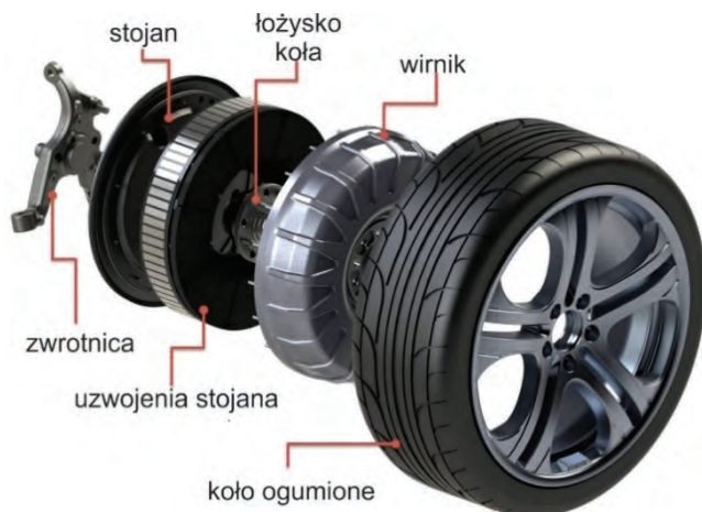
Rys. 5. Schemat budowy silnika typu HUB [2]
