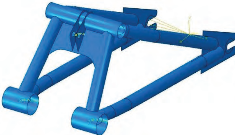
Rys. 3 Model powierzchniowy wahacza z oznaczonymi punktami referencyjnymi
