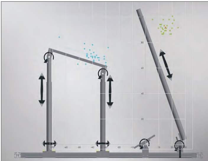
Rys. 3. Chmura punktów naniesiona na wykres, niebieskie punkty wyznaczają położenie stawu biodrowego, czerwone natomiast to położenie uchwytu
