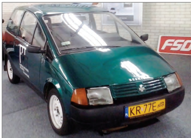
Rys. 2. Przykład konstrukcji jednobryłowej – FSM Beskid 2
