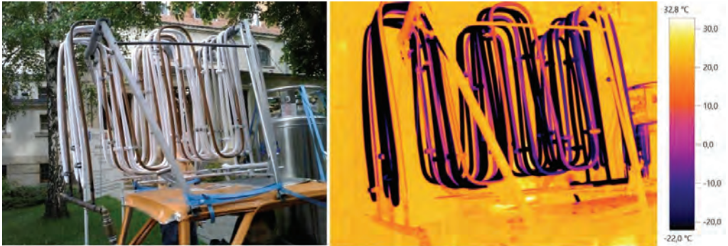
Rys. 6. Obraz wymiennika wykonany kamerą termowizyjną
