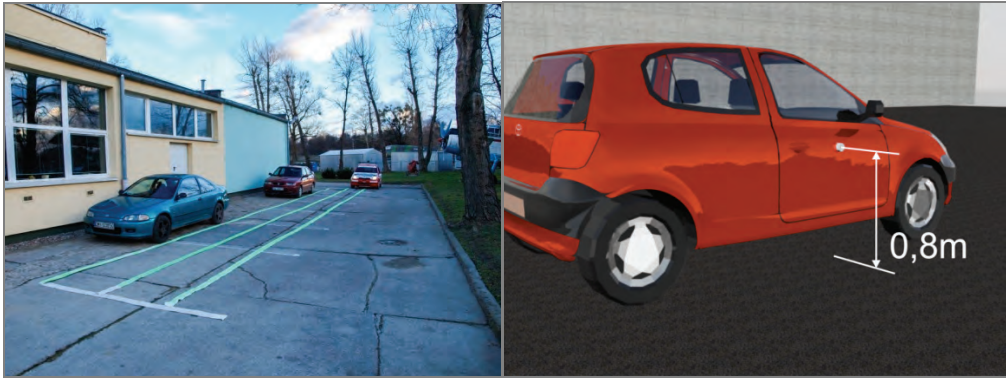
Rys. 7. Realizacja pomiaru dynamicznego oraz wizualizacja miejsca zamocowania czujnika
