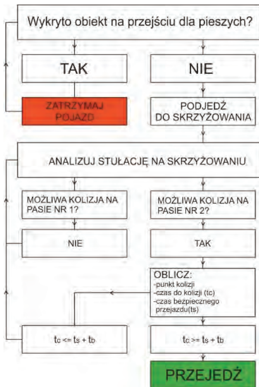
Rys. 7. Schemat blokowy algorytmu decyzyjnego – dla przejazdu przez skrzyżowanie
