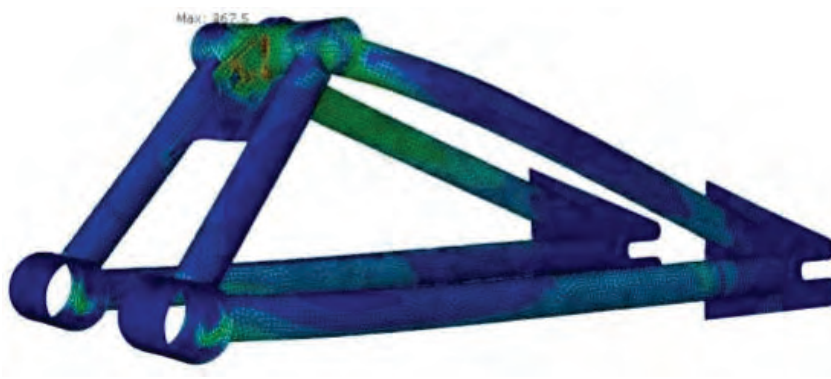
Rys. 4. Wyniki analizy – maksymalne naprężenia równe 362,5 MPa wg Hipotezy Hubera–Misesa
