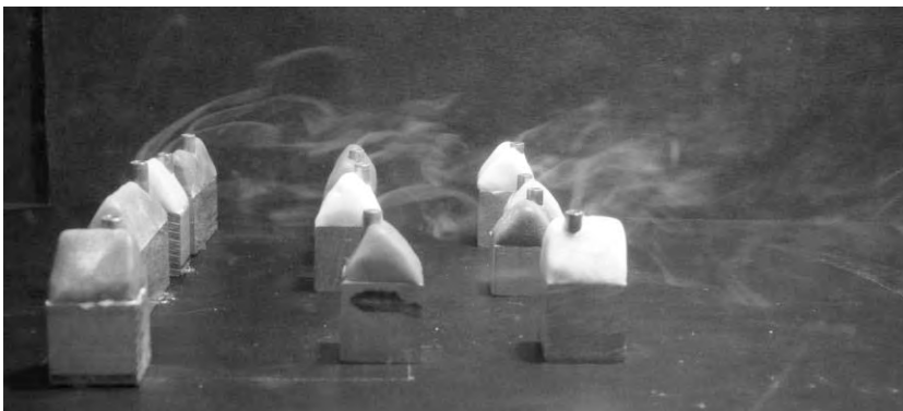
Rys. 5. Dyspersja zanieczyszczeń przy kierunku wiatru prostopadłym do osi zabudowy
