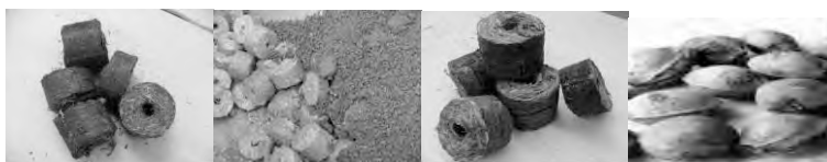
Rys. 3. Brykiety kolejno: z siana, słomy żytniej z peletami z łusek kawy, miskantusa oraz pestki wiśni
