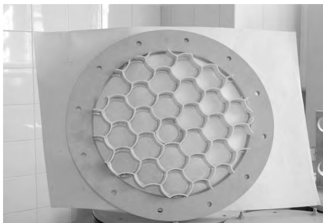
Rys. 6. Widok półki sitowo-komórkowej (wewnątrz montażowego pierścienia kołnierzonego o średnicy 380 mm widoczny jest zespół otworów nazwanych w tej pracy komórkami)
