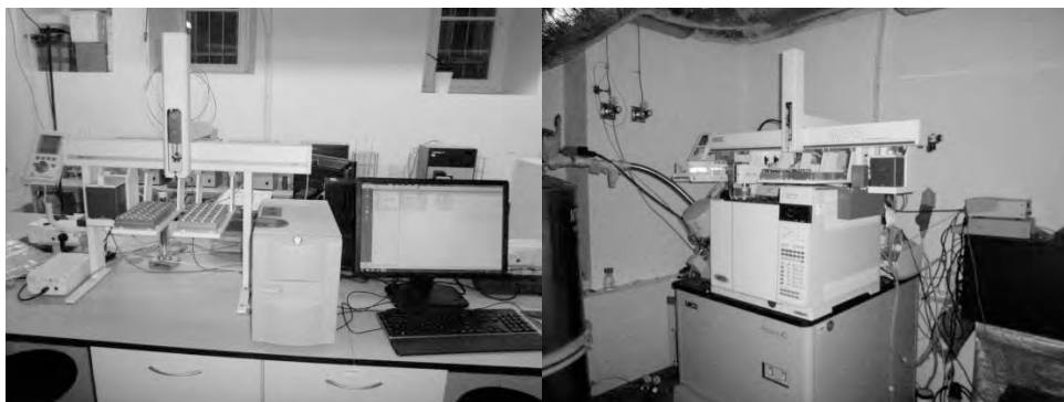
Rys. 2. Urządzenia wykorzystywane w analizie chromatograficznej; po lewej - elektroniczny nos (HERACLES II) typu fast GC, po prawej - chromatograf gazowy GC/GC-TOF-MS
