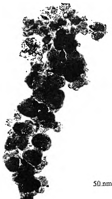
Rys. 15. Zdjęcie nanocząstek srebra otrzymanych w procesie sonoelektrochemicznej redukcji emulsji AgBr wykonane techniką transmisyjnej skaningowej mikroskopii elektronowej [185]
