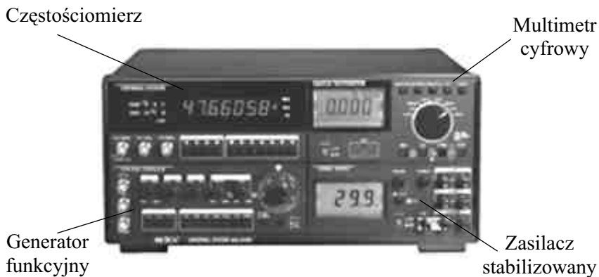
Rys. 3.27. Widok od przodu zestawu pomiarowego MS-9150
