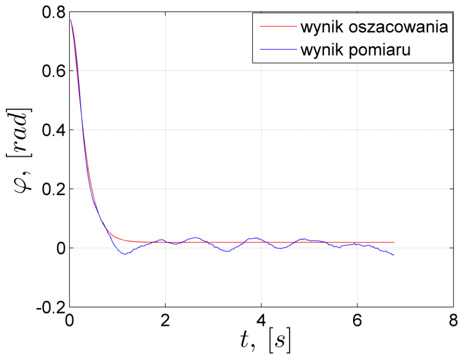
Rys. 63. Porównanie wyników pomiaru i oszacowania dla początkowego kąta skręcenia \varphi=\pi/4 rad.
