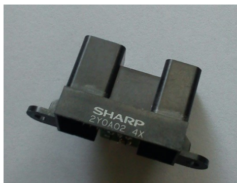
Rys. 44. Zdjęcie czujnika zbliżeniowego SHARP 2Y0A02 użytego obu konstrukcjach.
