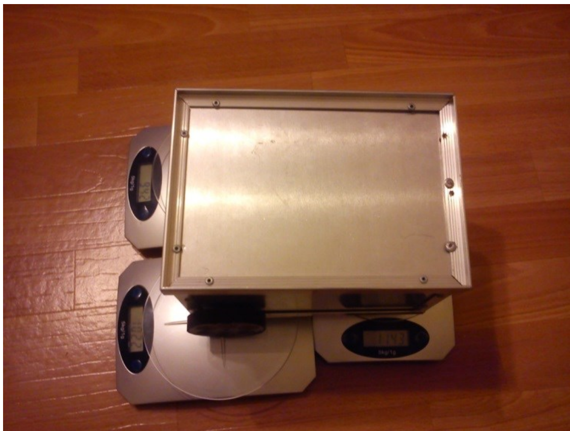
Rys. 76. Układ pomiarowy do pomiaru zmian wartości sił nacisku w robocie eksperymentalnym [106].
