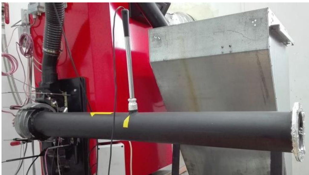
Rys. 3.4. Wentylator nadmuchowy RV-13 wraz z rurą i czujnikiem prędkości powietrza.
