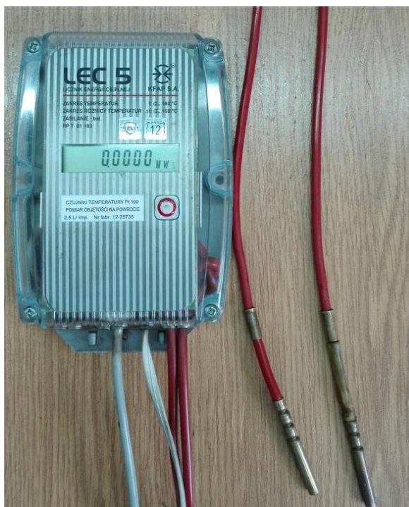
Rys. 3.8. Ciepłomierz LEC 5 z parowanymi czujnikami temperatury Pt100 .
