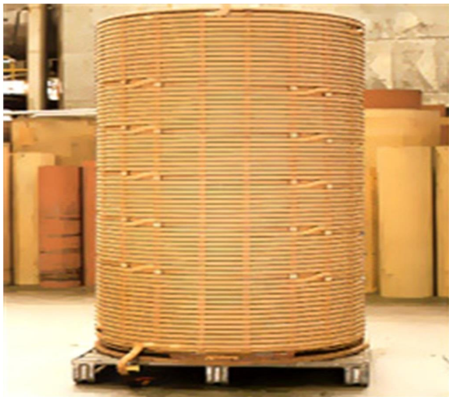
Rys. 3.4. Uzwojenie transformatora olejowego wykonane na bazie celulozy [153]
