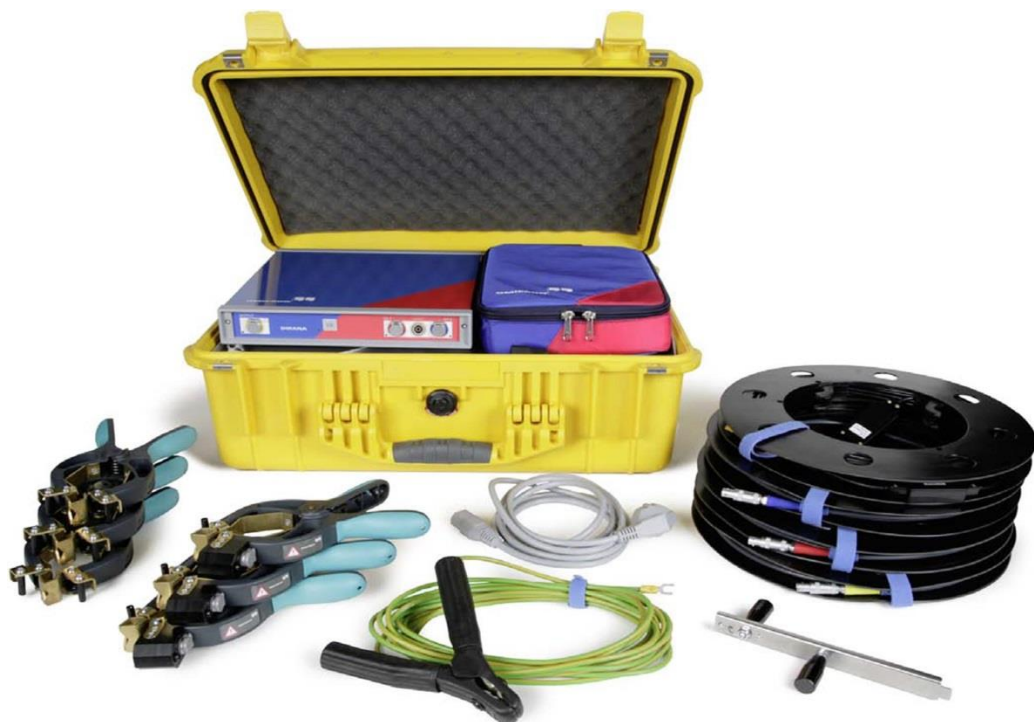
Rys. 4.5. Miernik DIRANA wraz z niezbędnym akcesoriami potrzebnymi do diagnostyki metodą FDS [26]
