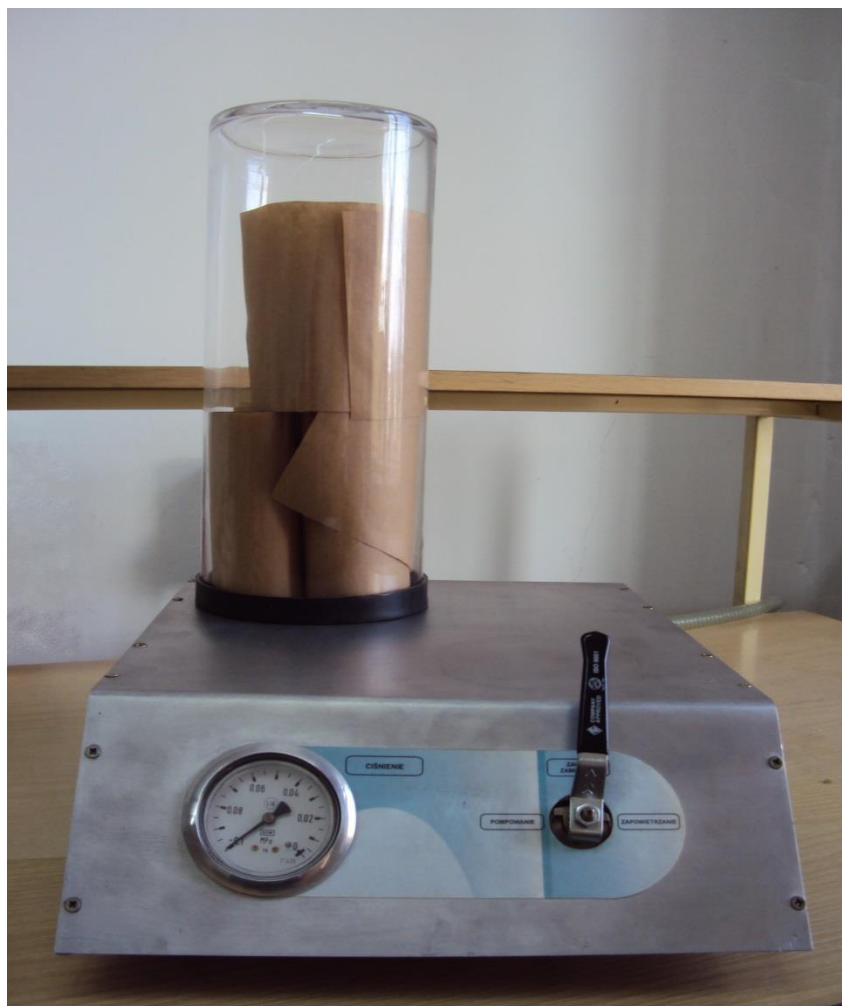
Rys. 6.7 Laboratoryjny układ próżniowy do suszenia papieru
