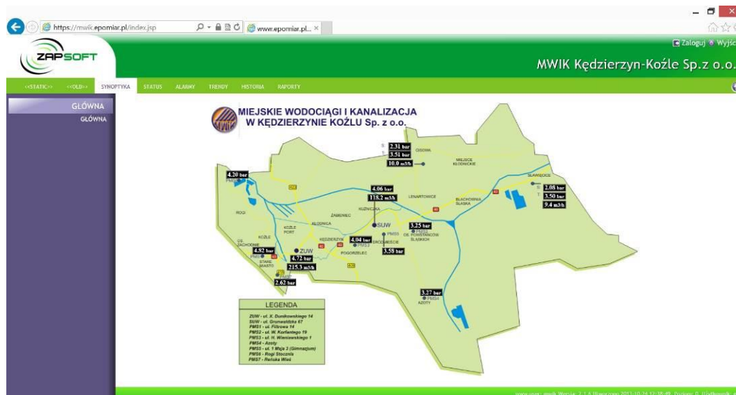
Rys. 3.22. Wizualizacja WWW – podgląd na wartości aktualne mierzonych parametrów w sieci
