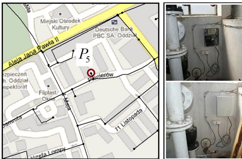
Rys. 3.15. Fotografia systemu pomiarowego PMS oraz lokalizacja punktu pomiaru P_5
