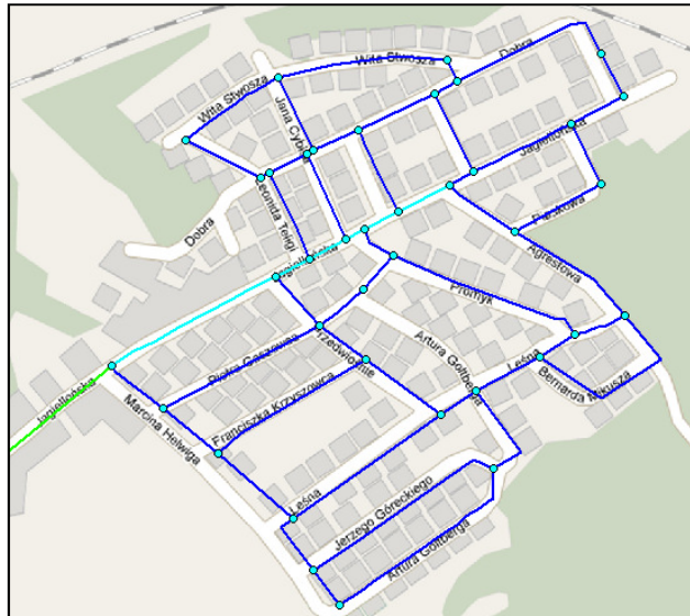
Rys. 2.2. Fragment szkieletu sieci jako przykład sieci wodociągowej pierścieniowej
