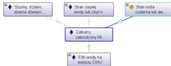
Rysunek B.20. Stan „Zatkany, zabrudzony filtr wody CWU” i odpowiadające mu części kotła, które mogły ulec awarii.
