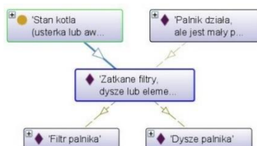
Rysunek B.29. Stan „Zatkane filtry, dysze lub elementy palnika” i odpowiadające mu części kotła, które mogły ulec awarii.
