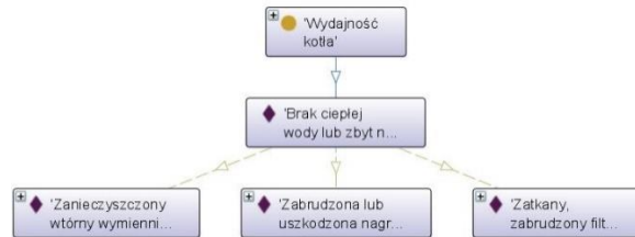
Rysunek B.1. Stany odpowiadające symptomowi „Brak ciepłej wody lub zbyt niska temperatura CWU”.
