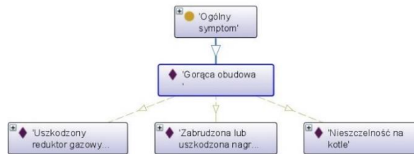
Rysunek B.6. Stany odpowiadające symptomowi „Gorąca obudowa”.
