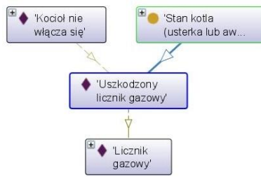
Rysunek B.22. Stan „Uszkodzony licznik gazowy” i odpowiadające mu części kotła, które mogły ulec awarii.
