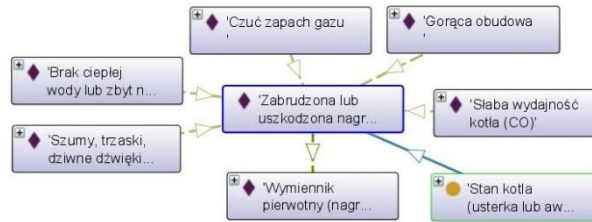
Rysunek B.23. Stan „Zabrudzona lub uszkodzona nagrzewnica” i odpowiadające mu części kotła, które mogły ulec awarii.
