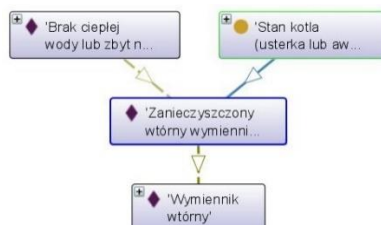
Rysunek B.31. Stan „Zanieczyszczony wtórny wymiennik ciepła” i odpowiadające mu części kotła, które mogły ulec awarii.
