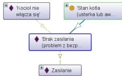
Rysunek B.15. Stan „Brak zasilania (problem z bezpiecznikami, zwarcie)” i odpowiadające mu części kotła, które mogły ulec awarii.
