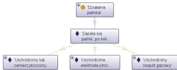
Rysunek B.5. Stany odpowiadające symptomowi „Zapala się palnik, po kilku sekundach gaśnie”.
