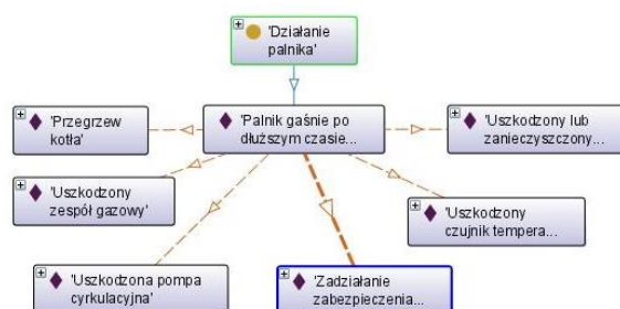
Rysunek B.4. Stany odpowiadające symptomowi „Palnik gaśnie po dłuższym czasie”.
