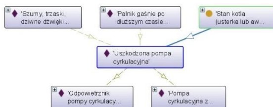
Rysunek B.27. Stan „Uszkodzona pompa cyrkulacyjna” i odpowiadające mu części kotła, które mogły ulec awarii.
