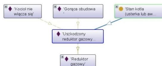
Rysunek B.28. Stan „Uszkodzony reduktor gazowy” i odpowiadające mu części kotła, które mogły ulec awarii.
