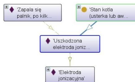
Rysunek B.17. Stan „Uszkodzona elektroda jonizacyjna” i odpowiadające mu części kotła, które mogły ulec awarii.
