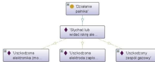
Rysunek B.11. Stany odpowiadające symptomowi „Słychać lub widać iskrę, ale palnik się nie zapala”.
