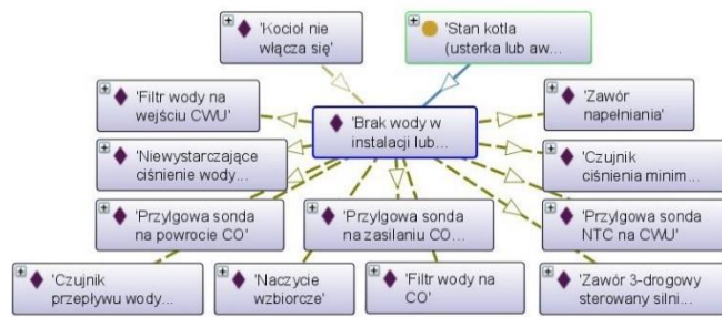
Rysunek B.14. Stan „Brak wody w instalacji lub kotle (lub niskie ciśnienie)” i odpowiadające mu części kotła, które mogły ulec awarii.
