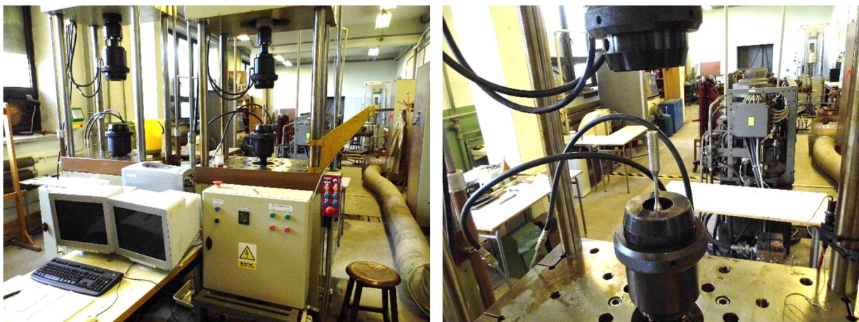
Rys. 9. Stanowisko SHM 250 do badań zmęczeniowych w jednoosiowym stanie naprężenia rozciąganiem-ściskaniem przy kontrolowanej sile.
