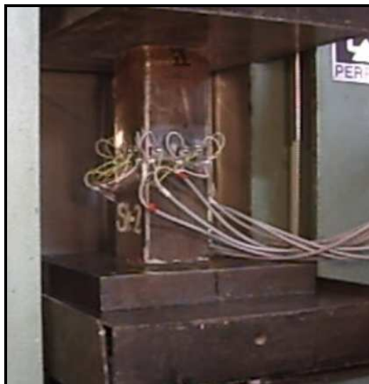
Rys. 28. Widok słupa krępego Sk-2 na stanowisku badawczym po zakończeniu badań
