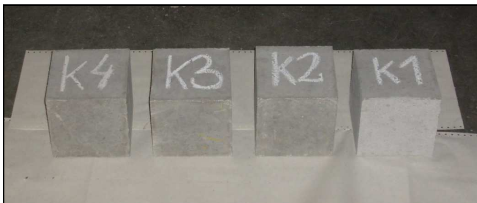
Rys. 13. Widok wykonanych betonowych próbek kostkowych
