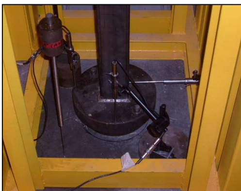
Rys. 22. Przewidywany sposoby podparcia smukłych elementów stalowo betonowych w trakcie badań:
