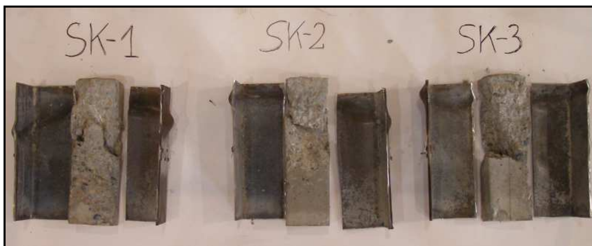
Rys. 38. Widok rdzenia betonowego po rozcięciu płaszcza stalowego w słupie SBK-1 (SK-1), SBK-2 (SK-2) oraz SBK-3 (SK-3)
