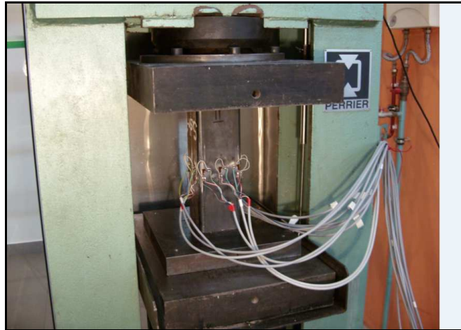
Rys. 19. Widok maszyny wytrzymałościowej typu ZPM 200 podczas badania krępego słupa zespolonego SBK-1
