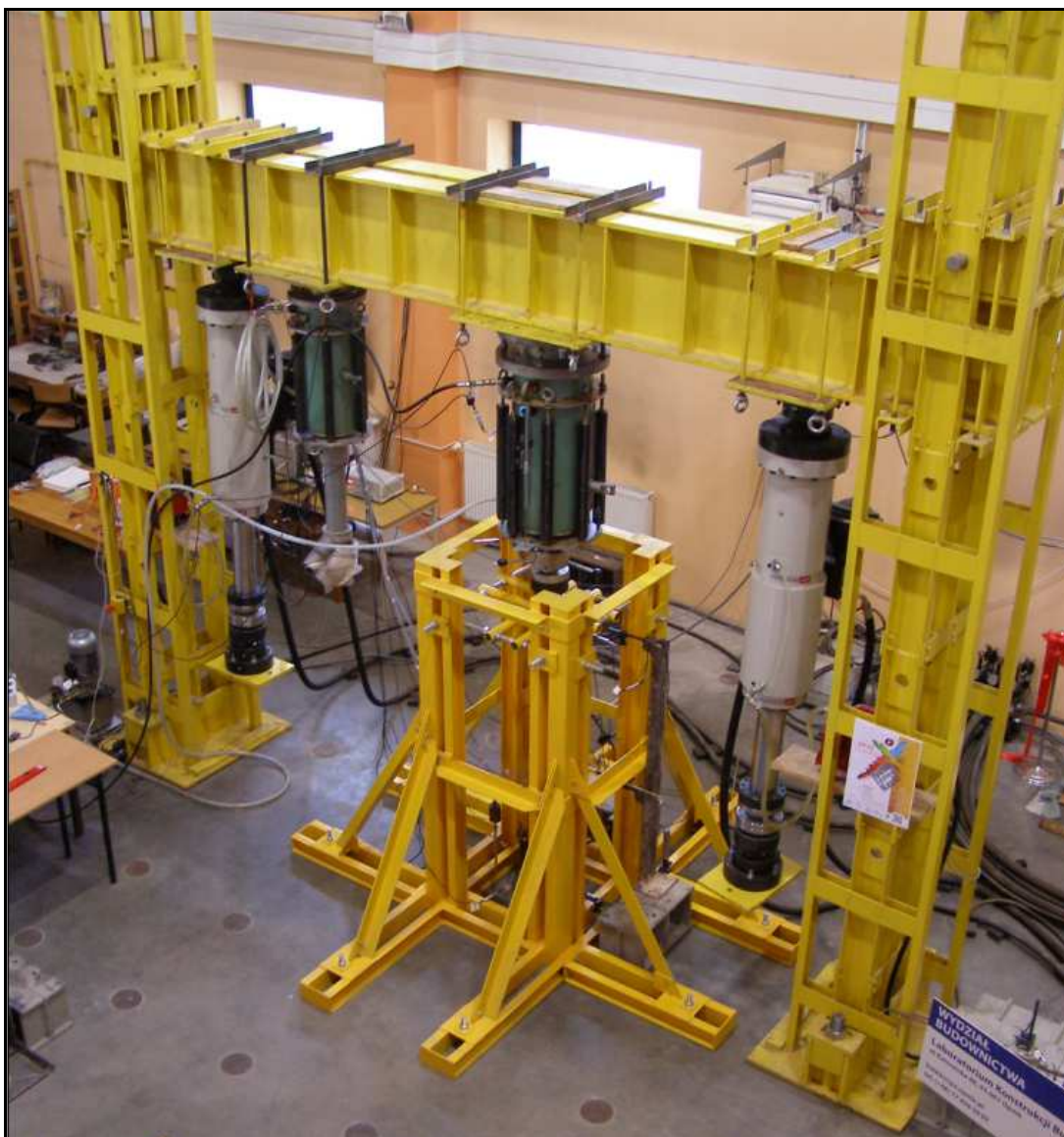
Rys. 23. Widok ogólny stanowiska do badania smukłych elementów stalowo-betonowych
