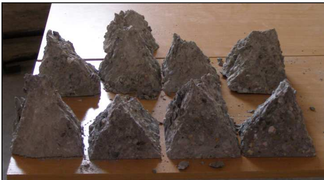
Rys. 17. Widok zniszczonych próbek kostkowych
