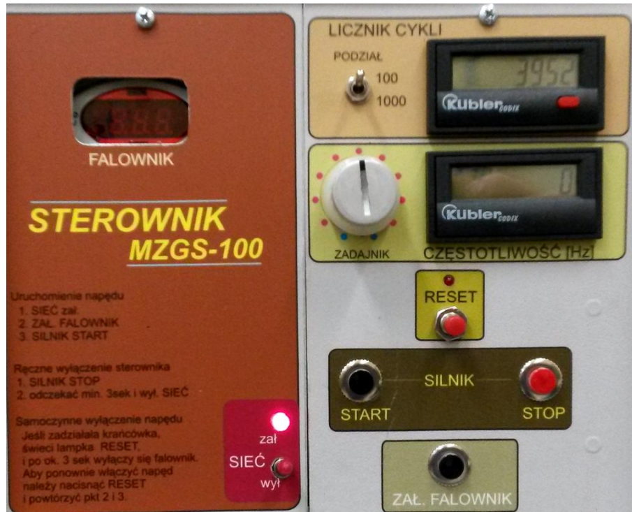
Rys. 8.2. Widok ogólny panelu frontowego sterownika stanowiska zmęczeniowego MZGS-100
