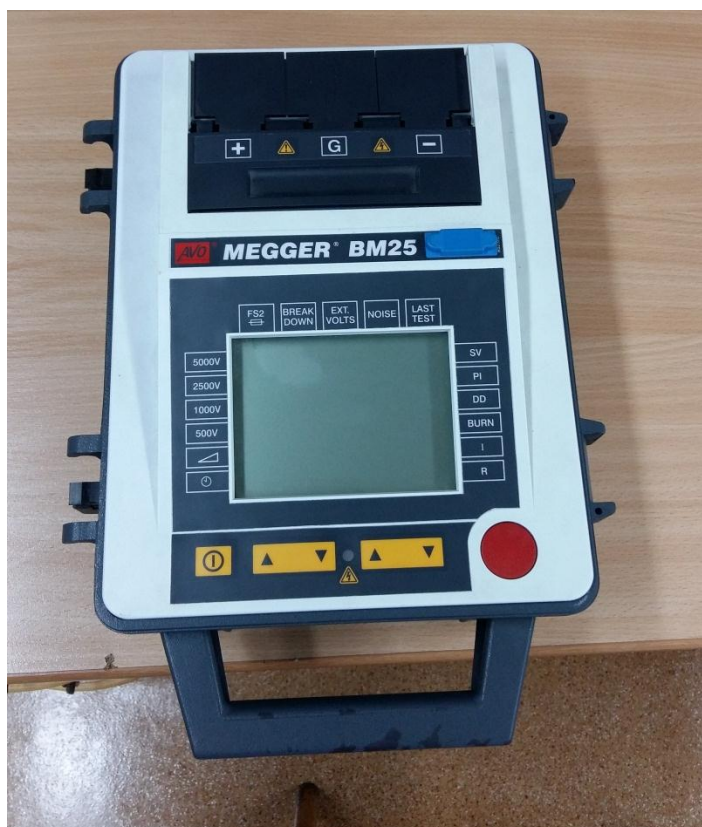
Rys. 8.3. Miernik Megger BM25 stosowany w układzie jako stabilne i bezpieczne źródło stałego napięcia
