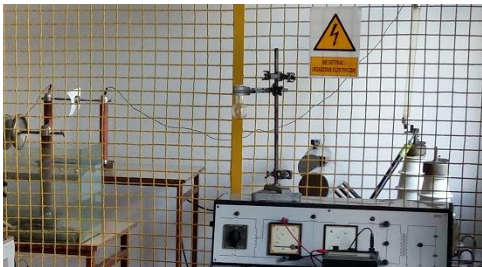
Rys. 7.1. Układ pomiarowy do sprawdzania napięcia przebicia próbek
