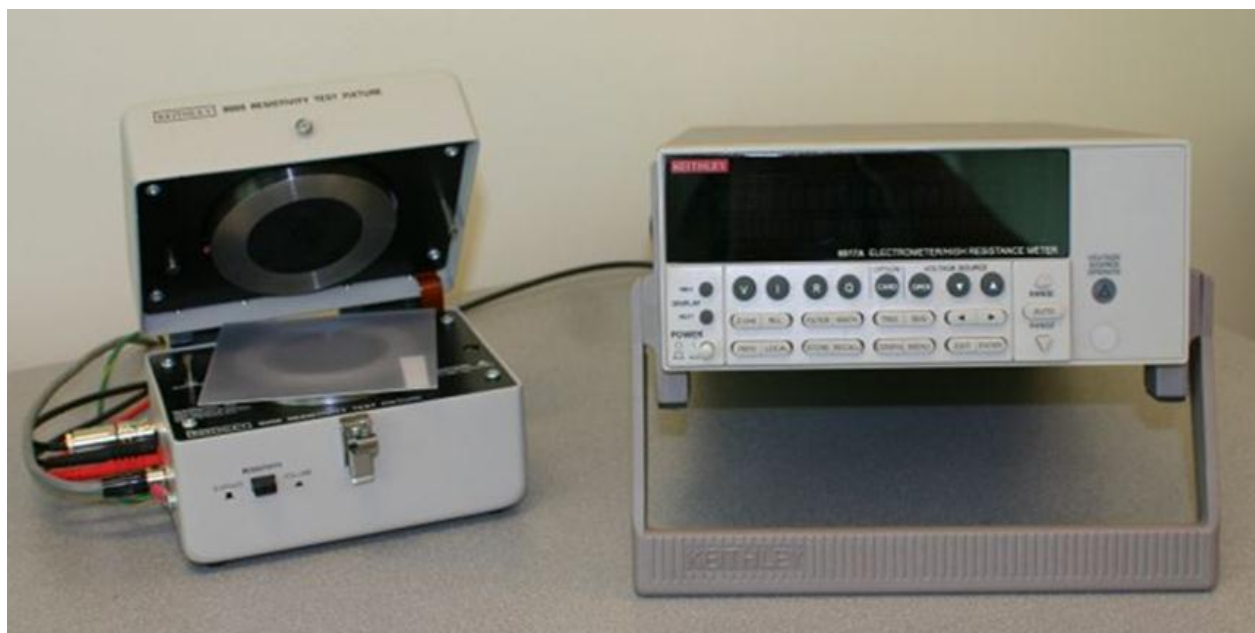
Rys. 7.3. Zestaw do pomiaru rezystywności skrośnej i powierzchniowej firmy Keithley, (od lewej: komora do pomiaru rezystywności Keithley 8009, elektrometr Keithley 6517A)
