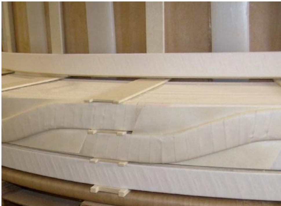
Rys. 4.2. Izolacja stała uzwojeń transformatora mocy wykonana z papieru aramidowego Nomex® serii 410 [24]
