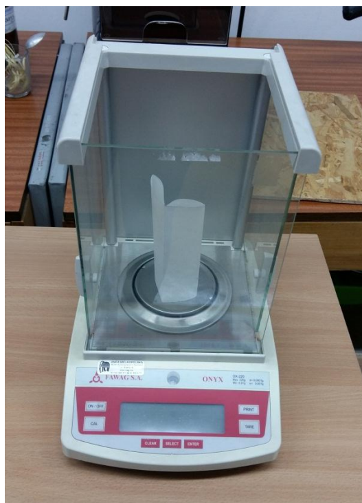
Rys. 8.6. Waga laboratoryjna Fawag typu ONYX OX-200 wraz z próbką papieru aramidowego
