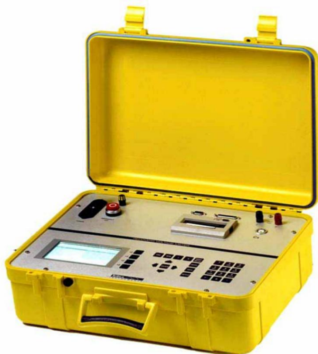
Rys. 6.9. Dedykowane urządzenie stosowane do pomiarów metodą RVM, 5462 - Recovery Voltage Meter firmy Haefely Hipotronics
