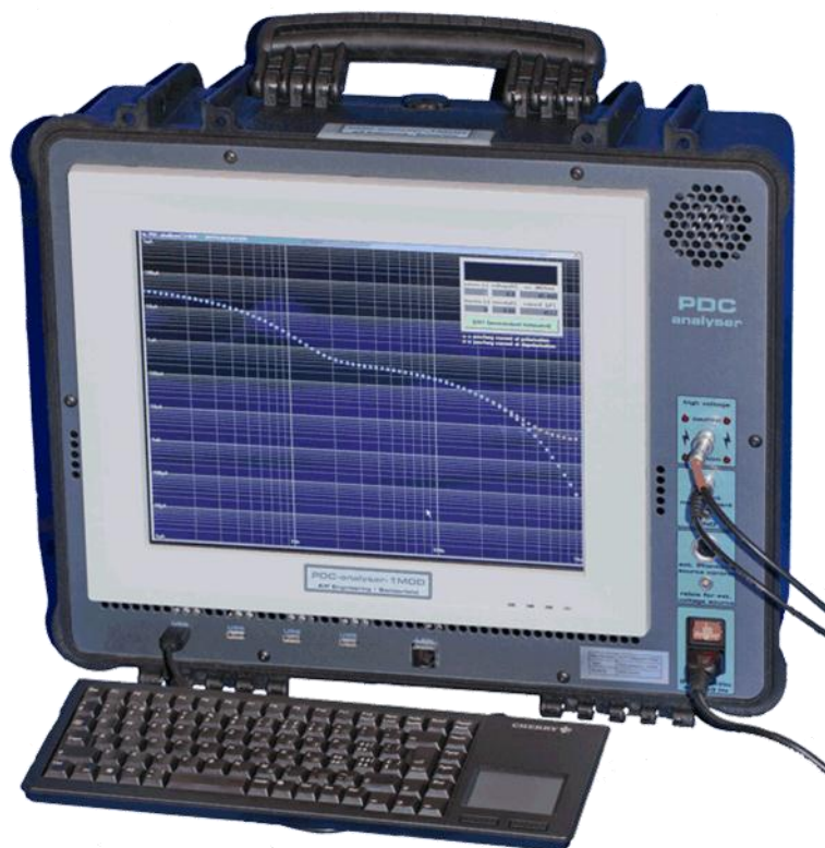
Rys. 6.4. Urządzenie do diagnostyki izolacji transformatora metodą PDC, PDC Analyser-1MOD firmy ALFF Engineering
