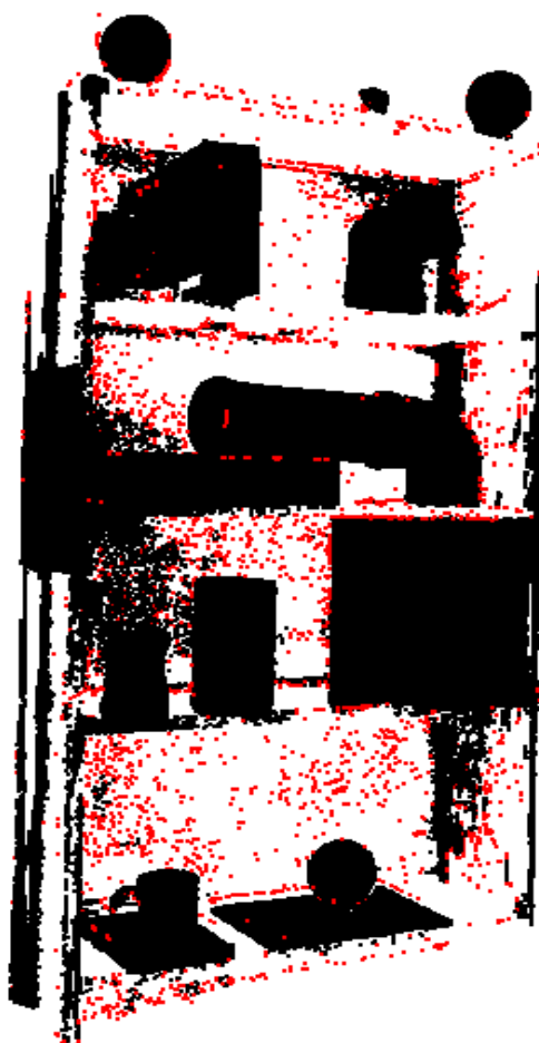
Rys. 4.3. Przykład wykorzystania filtracji na bazie wykrywania zagęszczenia punktów
