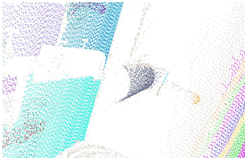
Rys. 8.7. Grupowanie utworzonych segmentów metodą RANSAC
