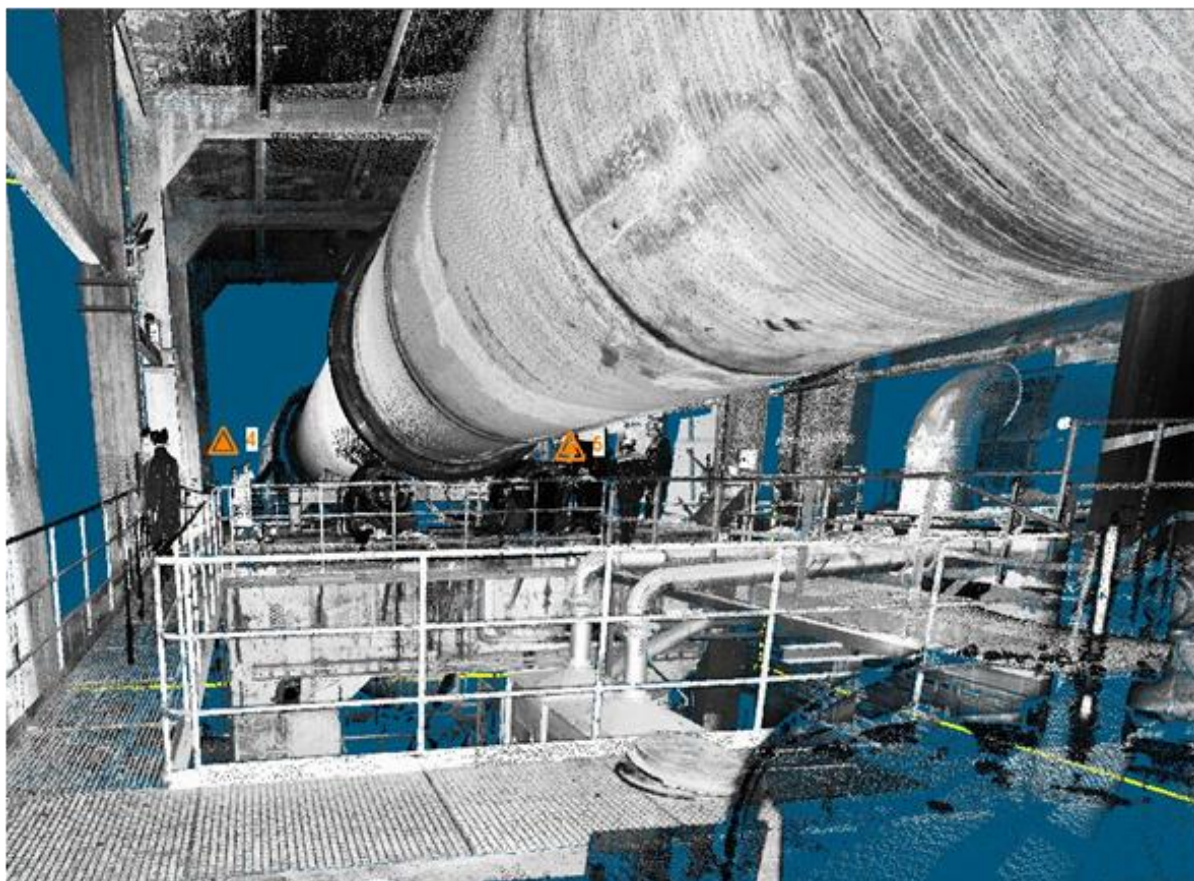
Rys. 3.2. Przykład wizualizacji chmury punktów ze skanera naziemnego
