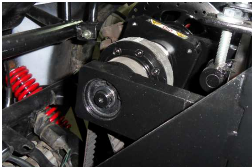
Rys. 10.9. Połączenie jarzma przekładni planetarnej z przekładnią zespoloną silnika spalinowego
