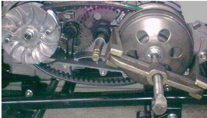
Rys. 10.2. Demontaż sprzęgła odśrodkowego
