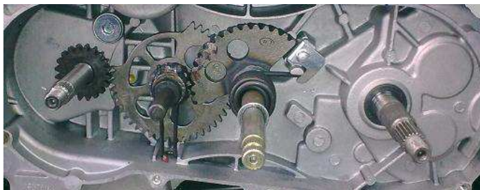
Rys. 10.3. Widok silnika po zdemontowaniu przekładni CVT
