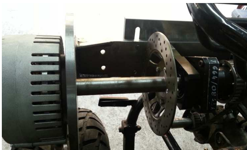
Rys.10.11. Połączenie maszyny elektrycznej z kołem słonecznym przekładni planetarnej
