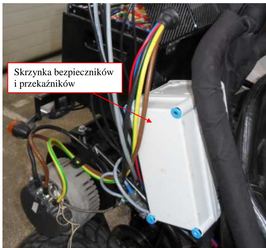
Rys. 10.20. Skrzynka bezpieczników i przekaźników układu zasilania pojazdu
